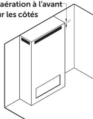
Charpente jusqu'au plafond, enchâssure minimale avec aération à l'avant ou sur les côtés
