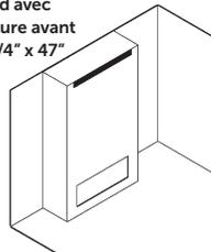
Charpente ouverte avec enchâssure à au moins 1-1/4" du plafond
