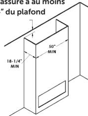
Charpente jusqu'au plafond avec aération avant et arrière
