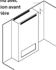
Charpente jusqu'au plafond avec aération à l'avant ou sur les côtés
