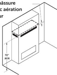
Enchâssure minimale avec aération à l'avant ou sur les côtés
