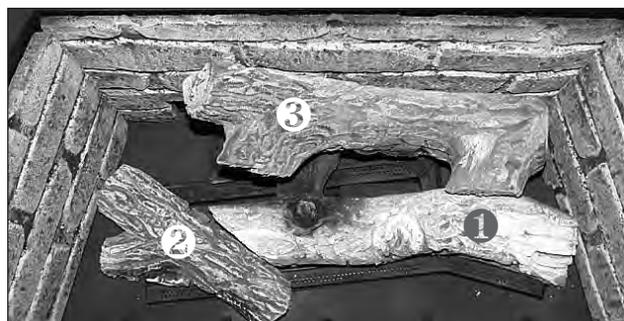
**Étape 4 :** (Remarquez le trou sur la bûche 4, au bas du noeud principal et sur la surface plane près du bout de la bûche) Soulevez la bûche 3 d'environ 2po et placez la bûche 4 sous le noeud du haut de la bûche 3. Positionnez le trou de la bûche 4 sur le lobe de positionnement de la bûche 1, déposez la bûche 3 en place tel qu'illustré. Placez la surface plane de la bûche 4 sur le support de bûche du brûleur arrière gauche et poussez vers l'arrière contre la languette.
