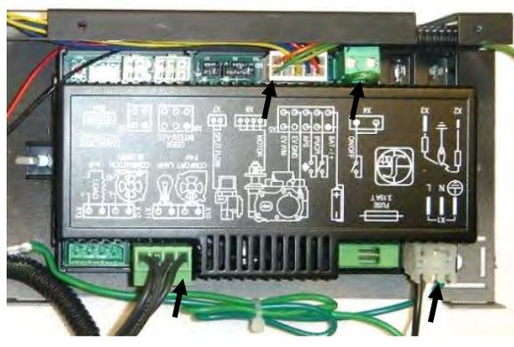
Étape 6: Le faisceau de câbles 584-924 (branché à la valve et au bloc-piles) a une **boucle de fil jaune identifié APS**. Coupez ce fil et **installez les fils de branchement** fournis avec le faisceau de câbles 584-X12.
