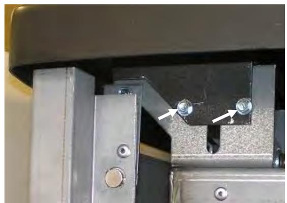
3. Une fois les crochets bien placés, insérez et serrez [1] vis DT dans les supports des côtés supérieurs de la façade du foyer. Remplacez les [2] vis (enlevées à l'étape 1) dans les supports du dessus de chaque côté de l'appareil.
