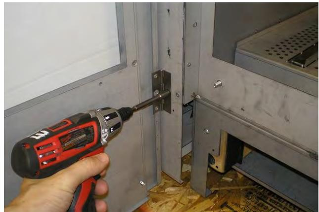
2. Avec les vis DT, ajustez la position des panneaux de portes latérales (un espace de 1/16" à 1/8" le long du bord est idéal).
