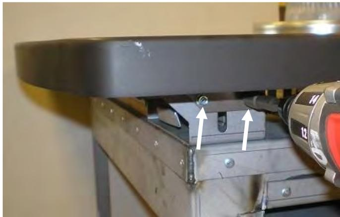
1. Enlever les [2] vis des supports du dessus, de chaque côté de l'appareil.
