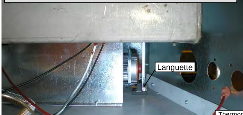
4. Placez le ventilateur sur les languettes.
