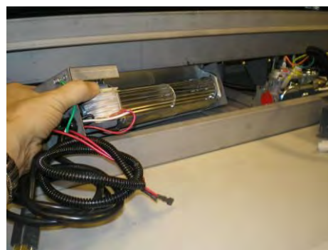
3. Insérez le ventilateur et placez-le au coin arrière droit de l'appareil.
