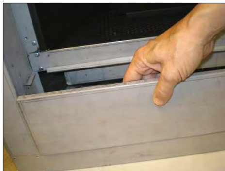
1. Enlevez le panneau inférieur de façade (Voir la section Retrait du panneau inférieur de façade du manuel).
