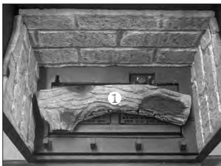
Étape 1 : Placez les encoches situées sur le dessous de la bûche 1 sur les languettes de positionnement 1A-1B.
