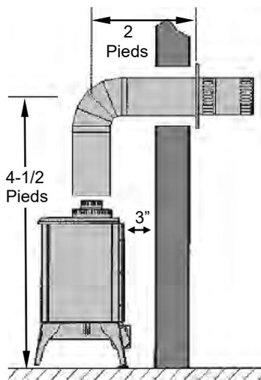
La longueur minimale est de 4 1/2 pieds avec l'appareil situé à 4po du mur.
