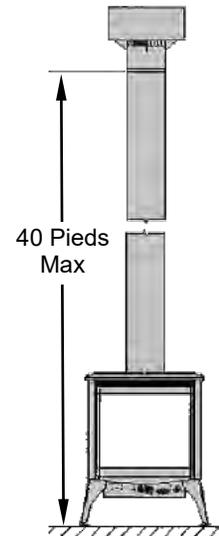
La longueur maximale de conduit vertical est de 40pi
