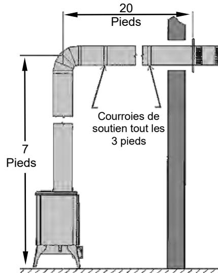
La longueur maximum d'un conduit d'évacuation comprenant un coude à 90 degrés est de 20pi avec 7pi vertical.
