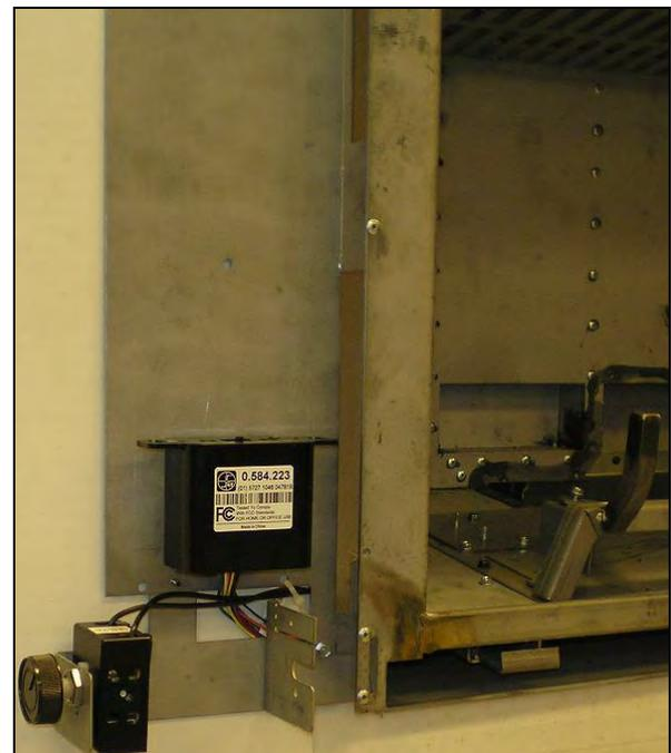
Emplacement du récepteur avec pièces à l'extérieur.
