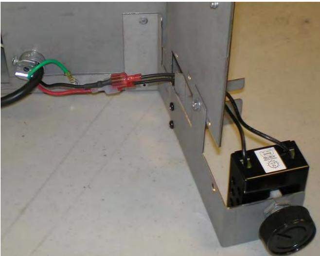
Fixez le support allongé du contrôle de ventilateur en utilisant [2] vis combo #6, tel qu'illustré.
