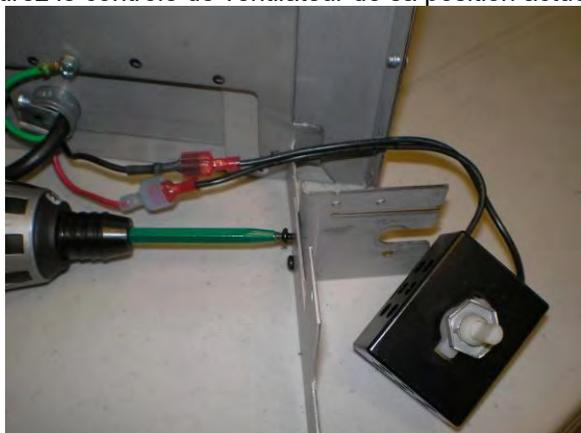
Fixez le support allongé du contrôle de ventilateur en utilisant [2] vis combo #6, tel qu'illustré.
