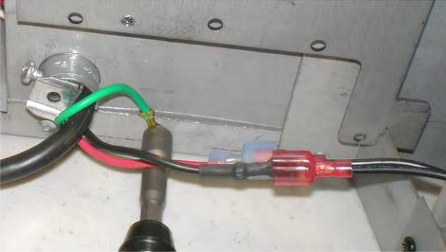
**N. B. :** Si le fil de mise à la terre est fixé à la plaque latérale des composants, défaites-le et fixez-le au côté de l'appareil avec une vis DT.
