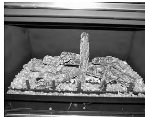
**ÉTAPE 13** - Saupoudrez la vermiculite sur les roches pour compléter l'assemblage des bûches.
