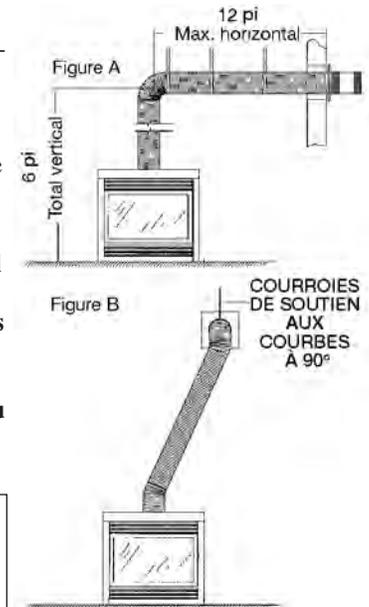
Pour les installations horizontales pour gaz propane il est recommandé qu'il y ait au moins 1pi de conduit vertical à partir du carneau du foyer avant le coude sur tout conduit horizontal de 1pi ou plus. Cela permet une combustion plus propre et réduit de beaucoup les dépôts de carbone et le besoin de nettoyer la vitre. (Ne s'applique pas aux modèles «Black Flue»)
