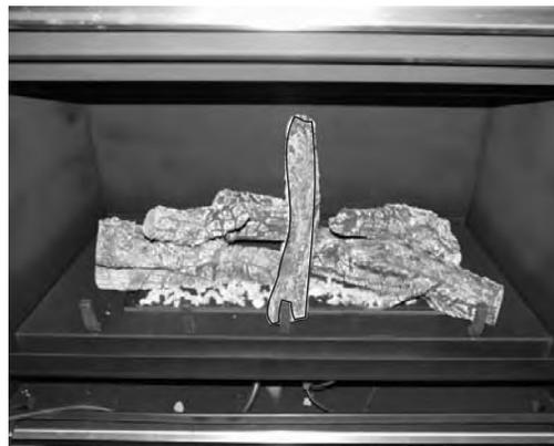
**ÉTAPE 9** - Sur la bûche 5, vous trouverez une encoche de positionnement qui s'alignera avec le barreau de grille du milieu. Glissez la en place et déposez la bûche 5 sur la zone plane de la bûche 2.
