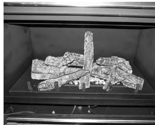
**ÉTAPE 11** - Penchez la bûche 7 contre la deuxième grille à partir de la gauche et placez-la dans l'encoche de la bûche 5. (ne pas placer sur les ports du brûleur)
