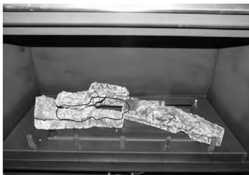
**ÉTAPE 6** - Trouvez les languettes de positionnement de la bûche 3. L'encoche de la bûche 3 doit être placée contre ces 2 languettes et par-dessus la bûche 1 (tel qu'illustré).
