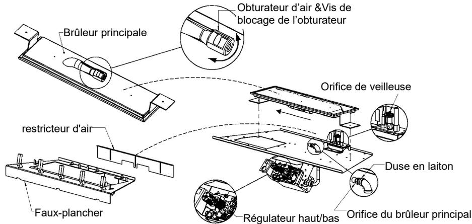
1. Enlever les [3]vis de bas qui tient le faux-plancher. Enlever les faux-plancher et restricteur d'air.
