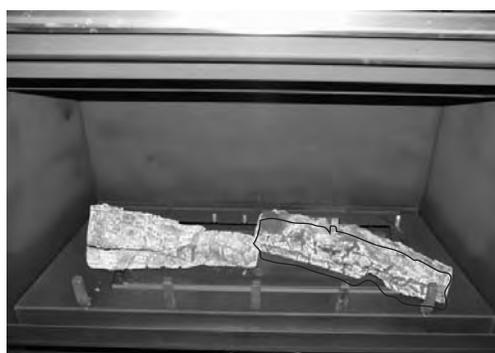
**ÉTAPE 5** - Trouvez la languette de positionnement pour le côté gauche la bûche 2. Placez la bûche 1 sur la languette en alignant celle-ci avec le trou de positionnement situé sur la bûche 2.
