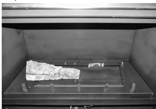
**ÉTAPE 4** - Trouvez la languette de positionnement pour le côté gauche la bûche 1. Placez la bûche 1 sur la languette en alignant celle-ci avec le trou de positionnement situé sur la bûche 1.
