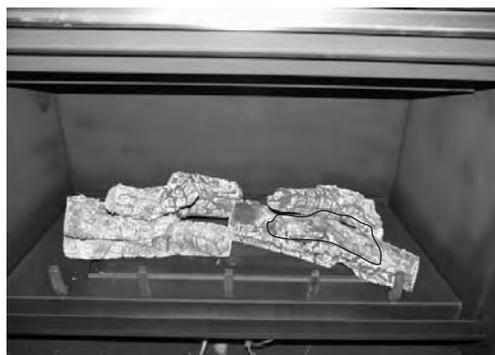
**ÉTAPE 7** - Trouvez la languette de positionnement de la bûche 4. à droite à l'arrière de la chambre de combustion. Poussez la bûche 4 jusqu'à la languette. Placez la petite branche en Y sur le rebord (section arrière) de la bûche 2. N.B. : Faites attention à ce que les bûches ne reposent pas directement sur l'ouverture des ports de gaz.
