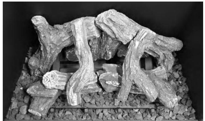
ÉTAPE 5 : Placez la braise incandescente à l'avant du tube de brûleur et des plaques de braise. Placez les roches sur le plateau de brûleur tel qu'illustré. NE PAS PLACER DE ROCHE SUR LE TUBE DE BRÛLEUR.
