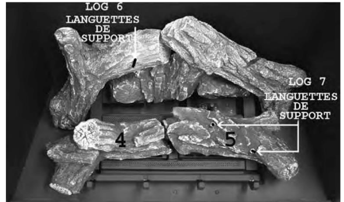
ÉTAPE 3 : Repérez les 2 trous sous les bûches #4 et #5. Placez les sur les languettes de placement des bûches de gauche et de droite.
