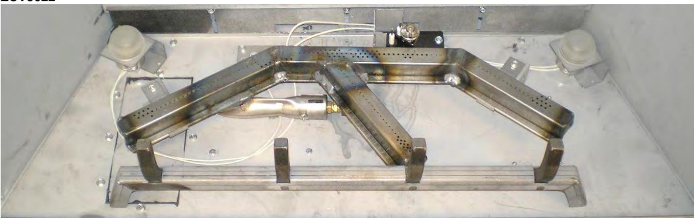
**ÉTAPE 3:** Positionnez les lampes dans la chambre de combustion. Fixez au foyer avec une vis aux endroits indiqués ci-dessus pour chaque appareil. Les lampes peuvent être pointées vers l'avant ou les côtés. Remplacez le tube du brûleur et le faux-plancher, ainsi que l'écran de veilleuse.
