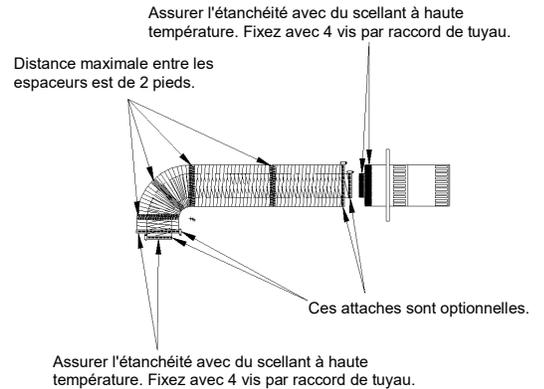
**N.B.** Il est primordial, pour assurer le fonctionnement sécuritaire et approprié de ce foyer, que tous les joints du conduit et de sa doublure intérieure soit scellés avec une bonne quantité de calfeutrant. N'utilisez que les rubans et scellant recommandés dans ce manuel. Scellant Mill Pac.
