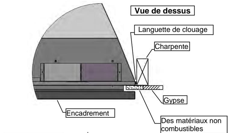
Les languettes de clouage doivent être pivotées à 180° et pliées sur la charpente
