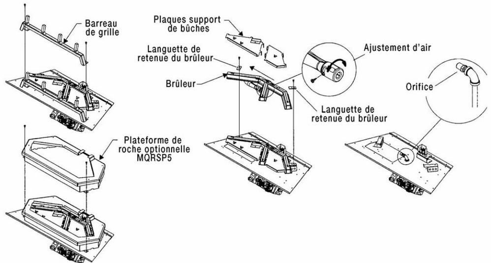
4. Retirez l'orifice principal en utilisant une clé de 1/2po et remplacez par le nouvel orifice de conversion.
