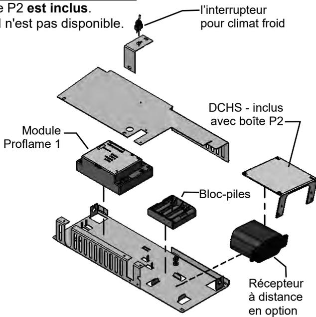
**NB : BLOC-PILES EST PAS NÉCESSAIRE SI LE RÉCEPTEUR À DISTANCE EST UTILISÉ**
