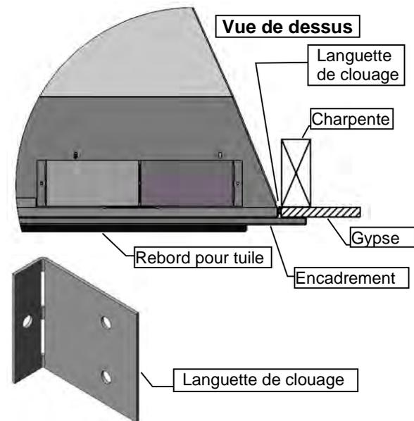
**Charpente à égalité avec la façade du foyer -** Le foyer doit être recouvert de matériaux non combustibles (ex. : panneau de ciment). **N.B. : 1/2" DOIT ÊTRE AJOUTÉ À LA PROFONDEUR DE CHARPENTE DE L'APPAREIL. UTILISEZ CETTE MÉTHODE POUR LES ENCADREMENTS ZCVRB3622.**
