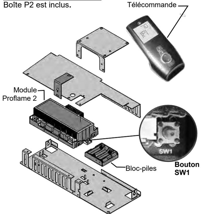
Si le panneau inférieur a été recouvert, on peut accéder aux piles par la zone d'accès, mais le plateau du brûleur doit être enlevé pour entretenir ou remplacer les composants (voir la section sur le **retrait du plateau du brûleur** de ce manuel).
