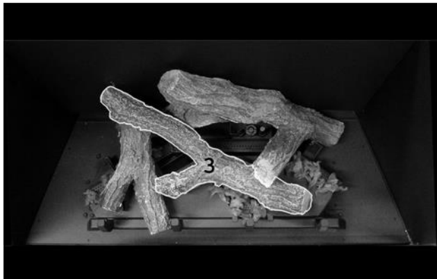
Étape 3 : Alignez les 2 trous au bas de la bûche #3 avec la languette de placement de la bûche #3, tel qu'illustré.
