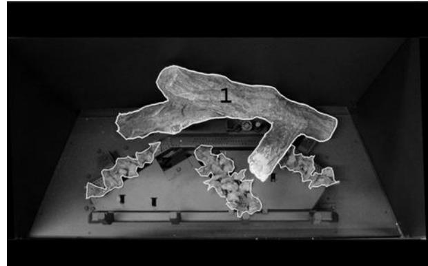
**Étape 1** : Placez les deux morceaux de la bûche #1 Sur le plateau du brûleur arrière en la glissant vers la gauche jusqu'au support du brûleur de droite.
