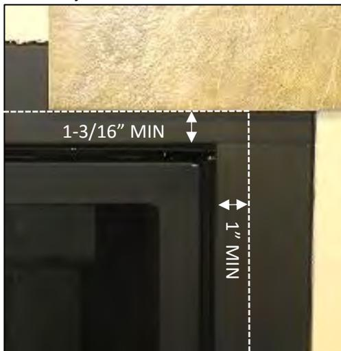
**IMPORTANT!** Si vous installez de la tuile, brique ou autre matériau non combustible autour du périmètre de l'écran : vous DEVEZ laisser 1" de façade découverte autour de l'ouverture du foyer au bas et sur les côtés, et 1-3/16" au-dessus. Ceci permet d'installer et enlever l'écran de sécurité. Voir les illustrations ci-dessous. **Un ensemble de bordure pour tuile est disponible. No de pièce ZCV-TLK.**
