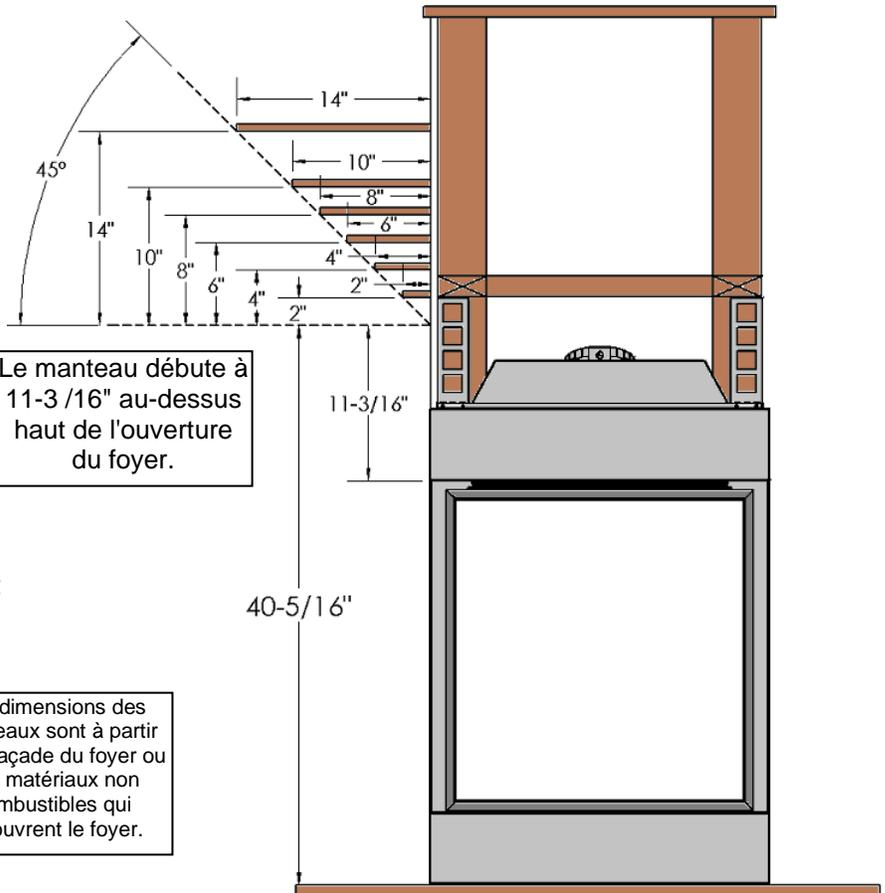
Les dimensions des manteaux sont à partir de la façade du foyer ou des matériaux non combustibles qui recouvrent le foyer.
