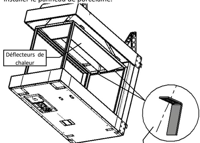
Dépliez les crochets de retenue pour les éloigner du mur. Dépliez-les pour fixer la doublure.
