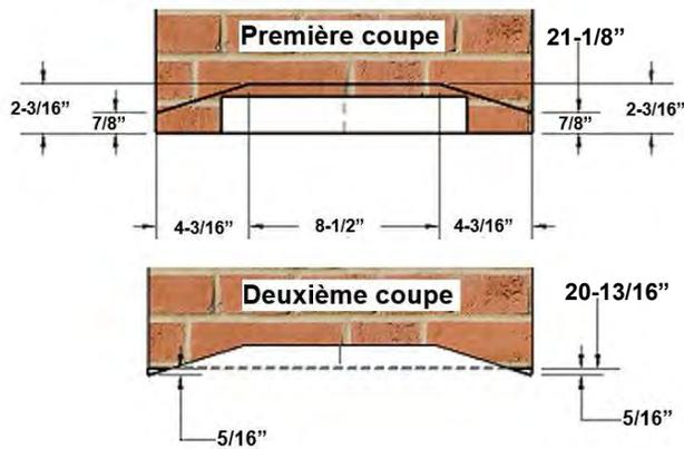
**N.B. :** La doublure de brique doit être installée **APRÈS** le MP42GT.
