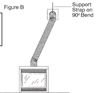
**Important :** La distance minimale entre le tuyau d'évacuation et les matières combustibles est de 1po (2.5cm)
