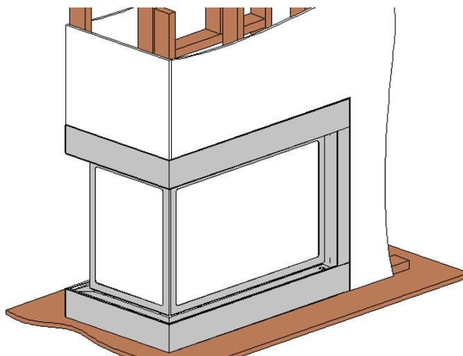
Avant d'installer quelque type de manteau que ce soit, il est important de déterminer si ses matériaux sont combustibles ou non. Il y a 2 types de manteaux à considérer : combustible et non combustible.
