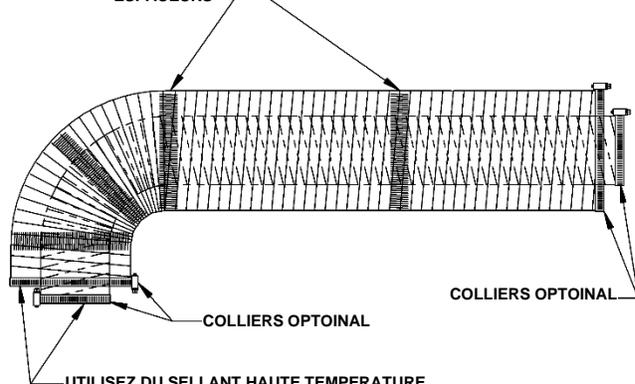
UTILISEZ DU SELLANT HAUTE TEMPERATURE. SECURE AVEC 4 VIS PAR JOINT DU TUYAU.
