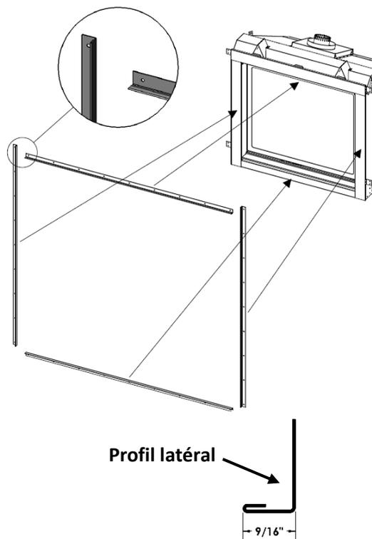
**Contenu de l'ensemble :** 4 pièces de rebord pour tuile de 47" de long, 12 vis.
