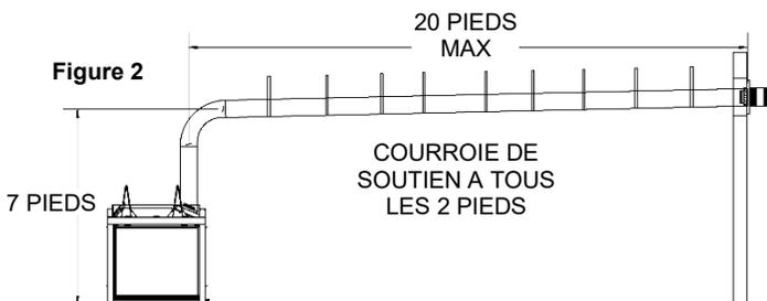
**Important :** La distance minimale entre le tuyau d'évacuation et les matières combustibles est de 1po (2.5cm)
