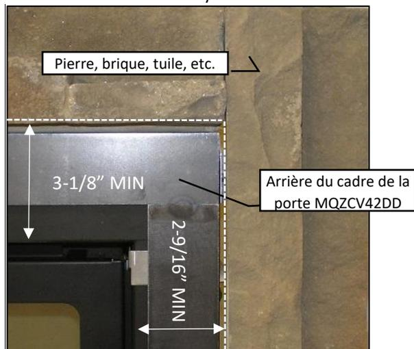
**IMPORTANT! :** Quand vous installez de la tuile, brique ou autre matériau non combustible autour du périmètre de l'encadrement : vous DEVEZ laisser 2-9/16" de la façade du foyer à découvert autour de l'ouverture du foyer sur les côtés, 2" au bas, et 3-1/8" en haut. Ceci permet d'installer et enlever l'écran de sécurité. Voir les illustrations ci-dessous. **Un ensemble de bordure pour tuile (ZCV-TLK) est disponible.**
