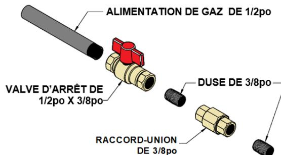
Dans l'état du Massachusetts une **valve d'arrêt à poignée en T** doit être utilisé avec tout appareil à gaz. Cette valve doit être certifiée et approuvée par l'état du Massachusetts en vertu du code CMR238 de l'état du Massachusetts.
