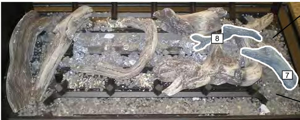
Placez roche de lave de M42LG sur des grilles et le fond de la chambre de combustion.
