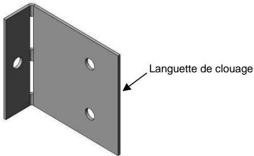
Les languettes de clouage doivent être pivotées à 180° et pliées sur la charpente
