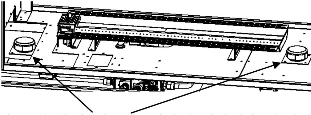
**ÉTAPE 1 :** Enlevez les couvercles et installez les lampes dans la chambre de combustion. Appliquez du scellant neuf (Mill-Pac).
