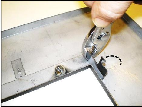
Placez l'encadrement face contre terre sur une surface protégée. Pliez le crochet supérieur et la languette inférieure de fixation de 90° vers le haut.
