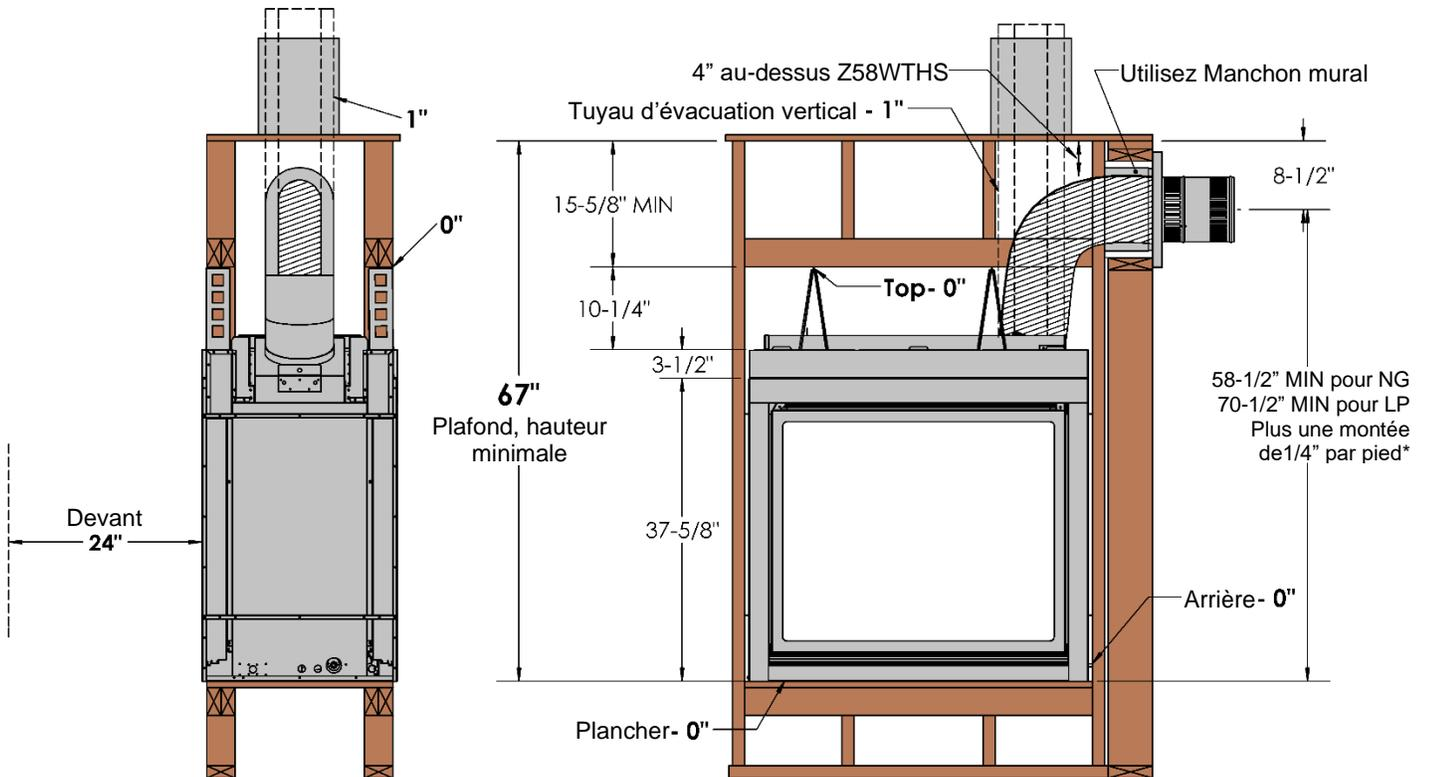
**Revêtement de sol en vinyle** – Les planches de vinyle de luxe (LVP), les carreaux de vinyle de luxe (LVT) et autres revêtements de sol en vinyle peuvent être sensibles à la chaleur radiante et aux changements de température. Nous recommandons d'installer une base d'au moins 12 pouces ou d'élever le foyer à au moins 24 pouces au-dessus du sol. **L'installation d'un revêtement de sol en vinyle se fait aux risques et périls de l'installateur.**
