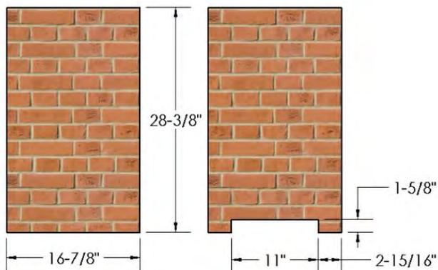
**N.B. :** La doublure de brique doit être installée **AVANT** le M42LG.
