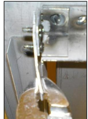
Pliez les crochets supérieurs et les languettes inférieures légèrement vers l'intérieur.
