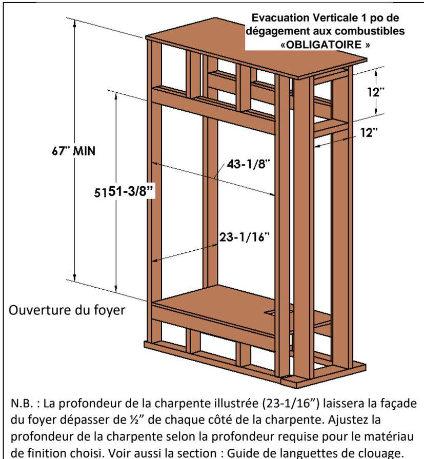
Découpe de plancher optionnelle pour conduite de gaz, si la conduite vient du plancher.
