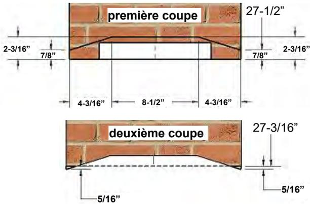
**N.B. : Les doublures de brique DOIVENT ÊTRE COUPÉS et installés APRÈS MST42GT est installé.**
