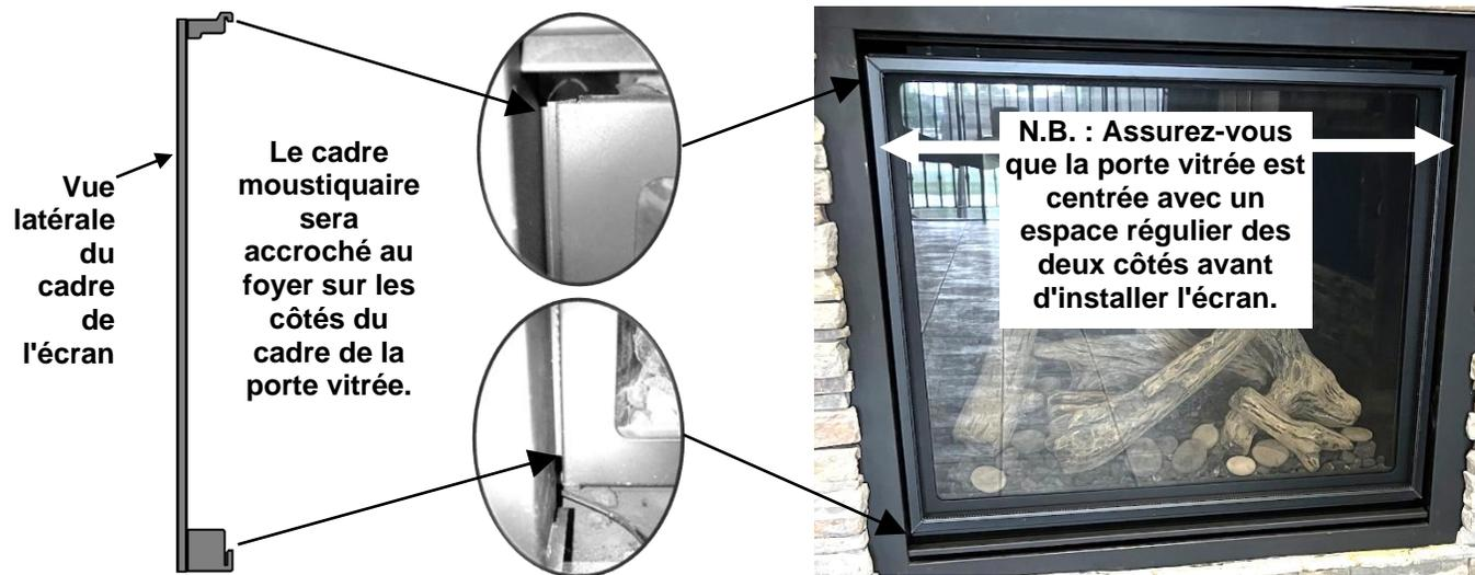
1. Retirez le panneau d'accès. Placez le bas de l'écran sur le support du panneau d'accès et poussez le cadre de l'écran vers l'intérieur jusqu'à ce qu'il s'arrête, comme indiqué ci-dessous. Lorsque l'écran est soulevé, les crochets inférieurs seront engagés.
