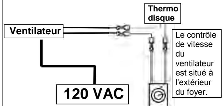
**N.B. : Ne laissez pas les câbles ou fils électriques entrer en contact avec la chambre de combustion ou le dessous du plateau du brûleur.**
