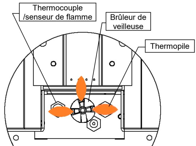
Il est recommandé d'allumer l'appareil au moins une fois par mois et d'en inspecter le patron de flamme pour vous assurer qu'il n'y a pas de problème de tube de brûleur. (Les flammes doivent ressembler à la photo ci-dessus).
