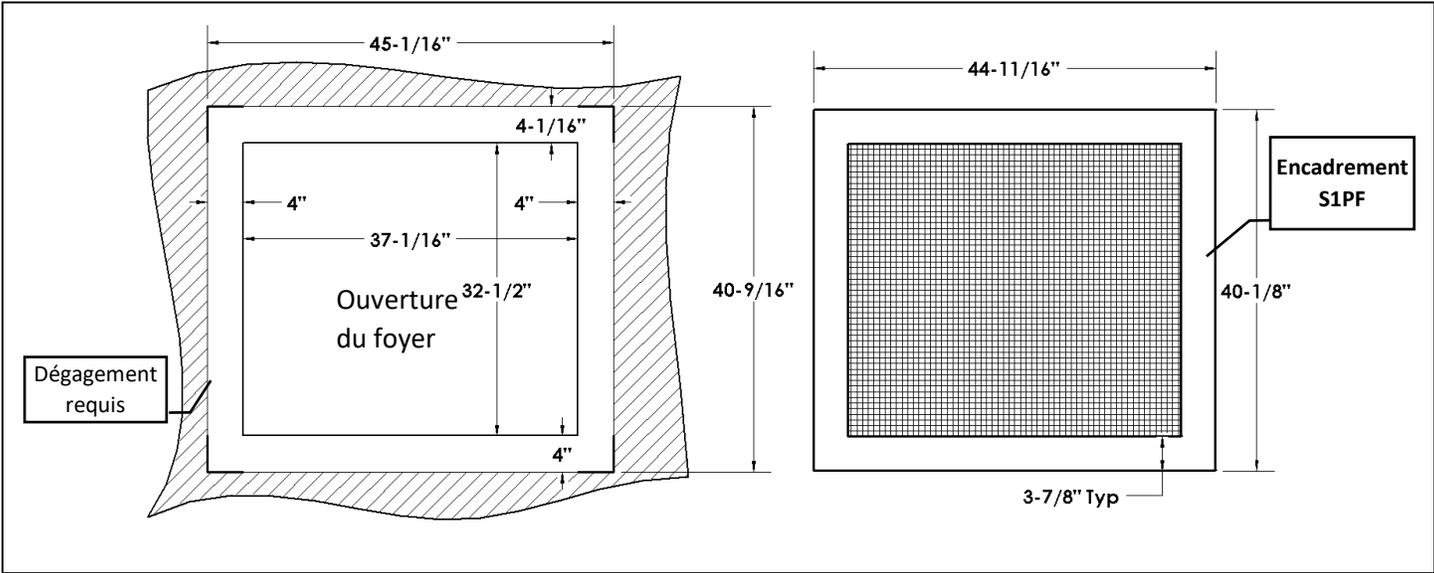
**MCVST42 : panneau de béton derrière l'encadrement S2PF (Épaisseur maximale de 3/4")**
