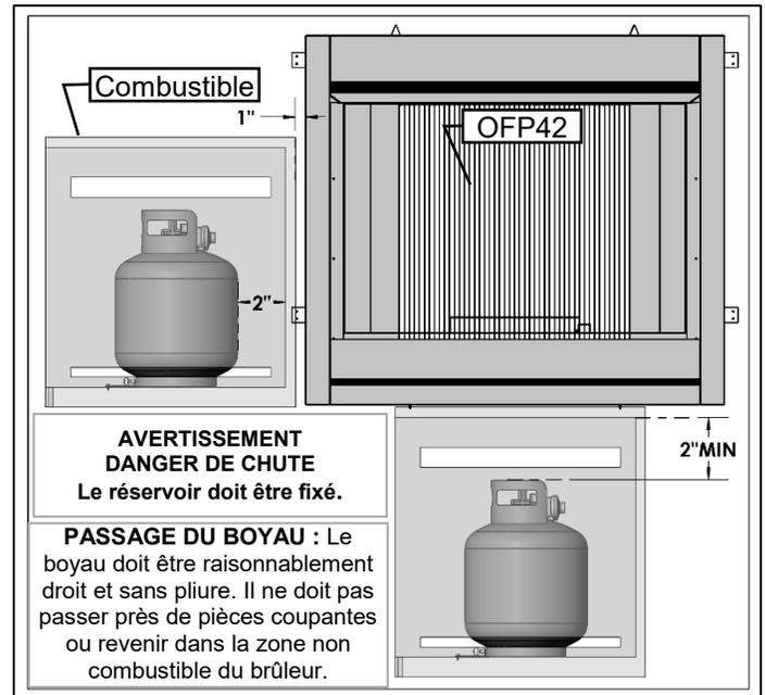
Il y doit y avoir une distance minimale de 2 po (50,8 mm) entre le plancher du compartiment du cylindre réutilisable de propane et le sol.
