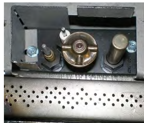
La veilleuse doit maintenir ce rapport avec le brûleur
