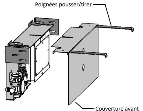
**OB 24/36/48 Brûleurs simples :** La boîte de soupape universelle doit être centrée avec l'emplacement pilote/allumeur. Le bord de l'ouverture sera à environ 3 5/8 po de l'extrémité gauche du brûleur.
