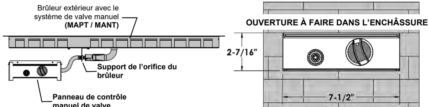
Le panneau de contrôle manuel de la valve doit être situé à 12" ou moins du support de l'orifice du brûleur.
