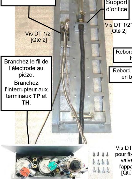
Branchez le fil de l'électrode au piézo. Branchez l'interrupteur aux terminaux TP et TH.
