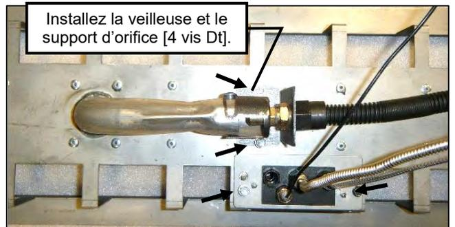
Installez la veilleuse et le support d'orifice [4 vis DT].
