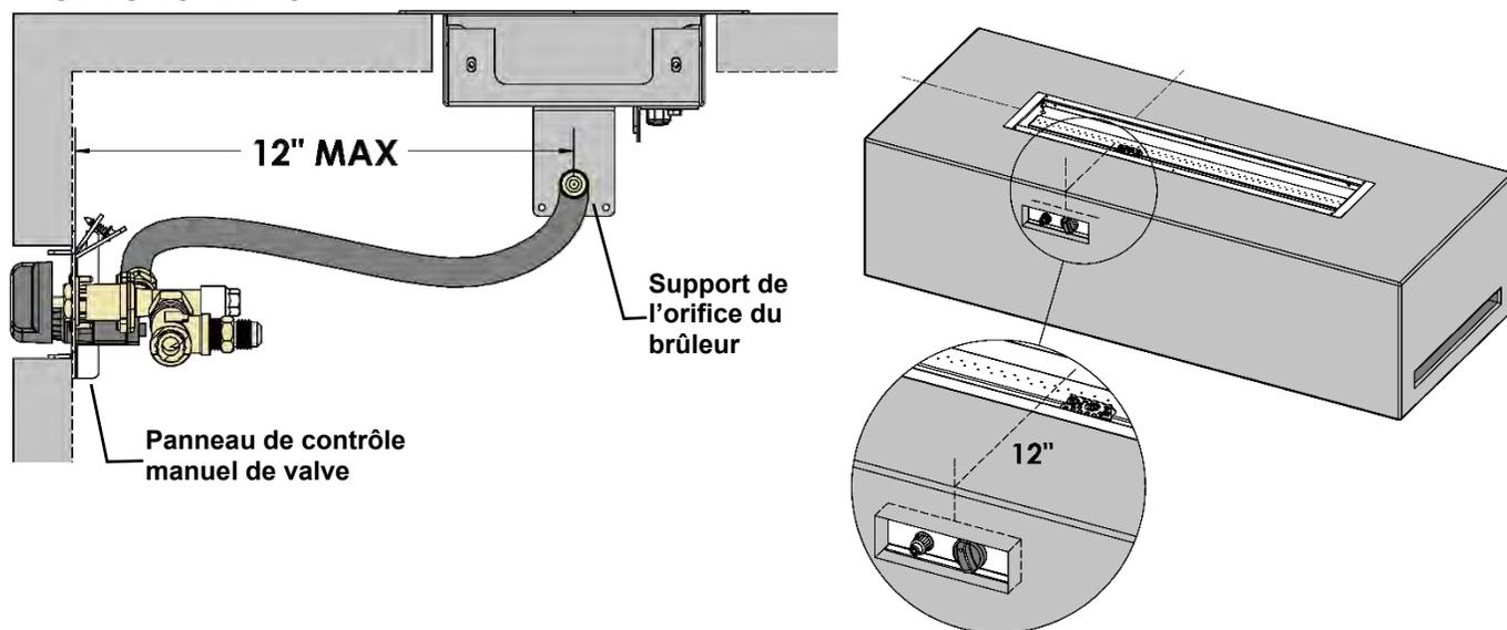
Le panneau de contrôle manuel de la valve s'insère à partir de l'intérieur de l'enchâssure et est retenu en place en serrant les 2 vis situées au dos du panneau de contrôle de la valve.
