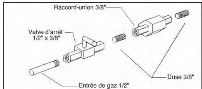
1. L'arrivée de gaz peut être branchée du côté droit ou du côté gauche de l'appareil. Il y a une entrée défonçable de chaque côté pour permettre de brancher et de tester la conduite de gaz.
