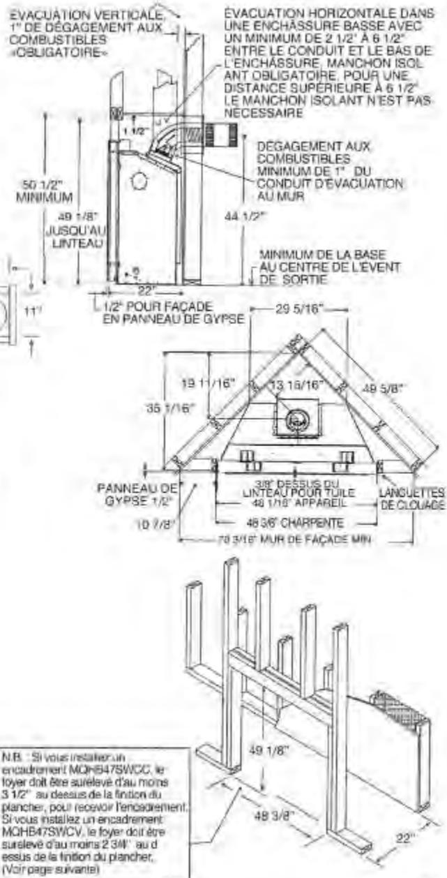
N.B. : Si vous installez un encadrement MQHB47SWCC, le foyer doit être surélevé d'au moins 3 1/2" au dessus de la finition du plancher, pour recevoir l'encadrement. Si vous installez un encadrement MQHB47SWCV, le foyer doit être surélevé d'au moins 2 3/4" au dessus de la finition du plancher. (Voir page suivante)
