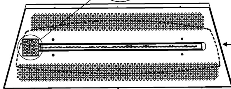
**Disposition de la braise de verre du ZDVRB3622 & MQRB4236:** Laissez 3-4 rangés de perforations libres à l'avant et à l'arrière du faux-plancher. Recouvrir toutes les perforations de l'arrière peut causer un retour de flamme.
