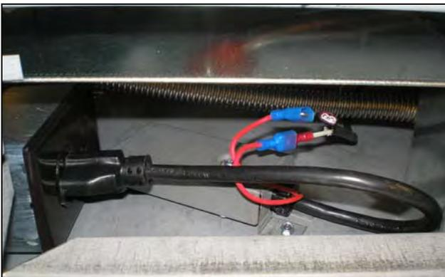
**ÉTAPE 4:** Branchez les fils de l'interrupteur entre le fil de la lampe et le transformateur (voir schéma). Branchez le fil de lampe restant au transformateur. Le transformateur peut alors être branché à la prise et le boîtier peut être fixé au bas du foyer.
