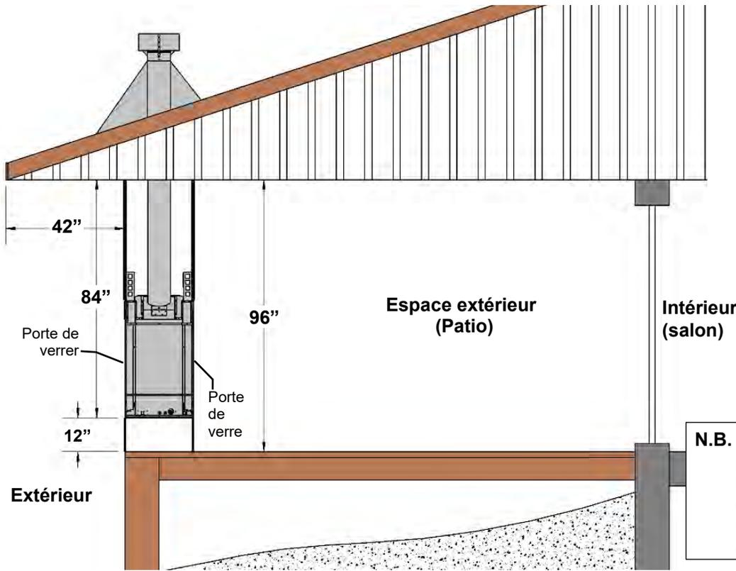
Tous les branchements électriques doivent être faits selon les normes d'installation extérieures de la RNUC et du NFPA 70.
