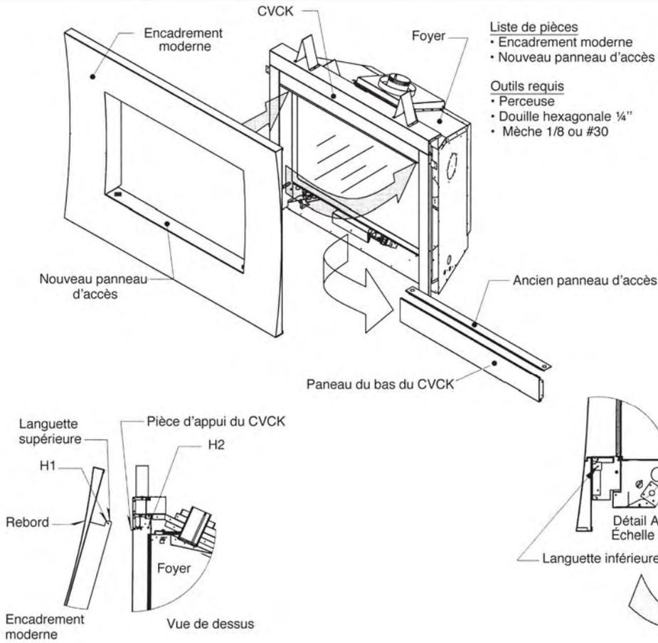
Enlevez l'ancien panneau d'accès et le panneau du bas du CVCK en dévissant les 2 vis et en perçant les 2 rivets.
