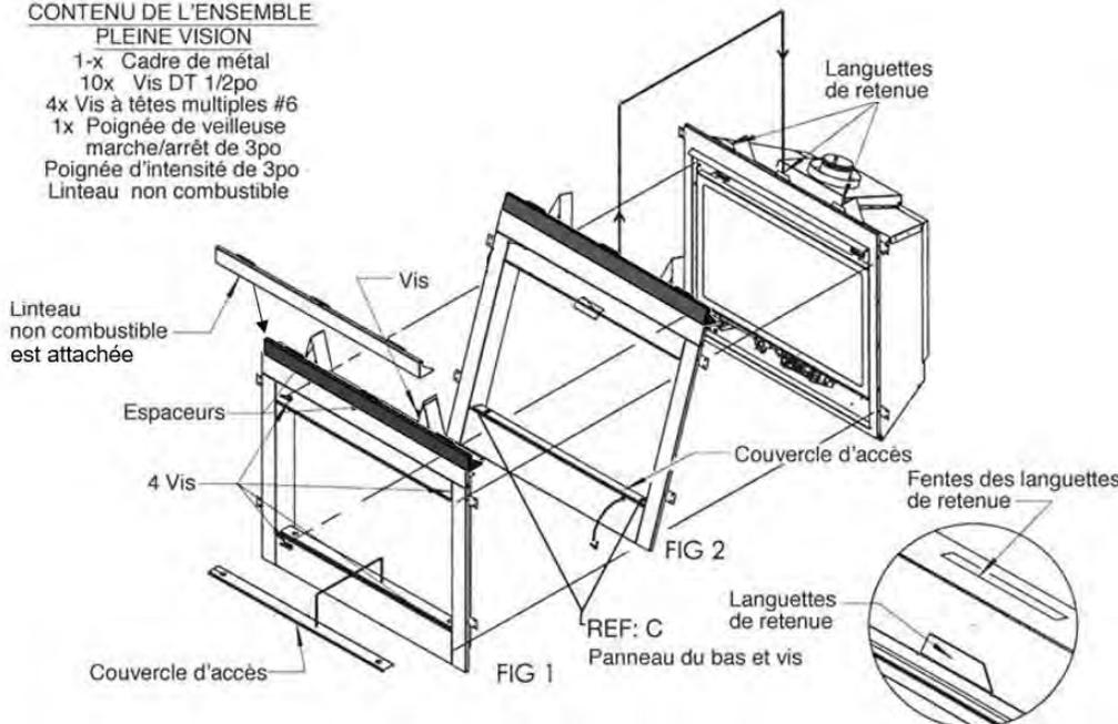
**N.B. :** Si vous utilisez l'ensemble pleine vision (CVCK) et que vous installez une ou plusieurs composantes électroniques en option (i.e. télécommande, contrôle à vitesse variable, et ou modules de ventilateur) celles-ci doivent être placées dans la zone accessible du CVCK, sauf si d'autre système de protection comme notre ensemble IPI est utilisé.
