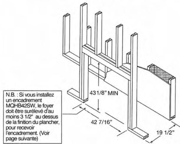
N.B. : Si vous installez un encadrement MQHB42SW, le foyer doit être surélevé d'au moins 3 1/2" au dessus de la finition du plancher, pour recevoir l'encadrement. (Voir page suivante)
