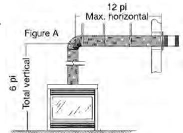
**N.B. :** L'emplacement final du foyer doit être tel que les dimensions du conduit horizontal soit les mêmes que celles mentionnées dans le tableau. La longueur maximale du conduit vertical est de 40pi (12,2m).
