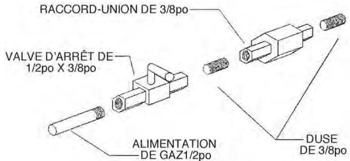
Dans l'état du Massachusetts une **valve d'arrêt à poignée en T** doit être utilisée avec tout appareil à gaz. Cette valve doit être certifiée et approuvée par l'état du Massachusetts en vertu du code CMR238 de l'état du Massachusetts.
