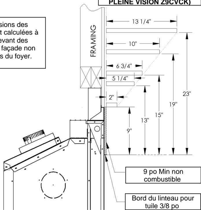
**Avertissement : Ne pas placer de matériel combustible sur un manteau non combustible sauf si le manteau non combustible respecte les dimensions minimales requises pour un manteau combustible.**
