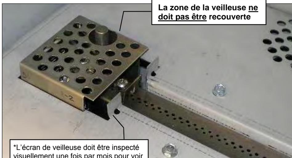
La zone de la veilleuse **ne doit pas être recouverte**
