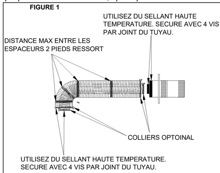
**N.B.** Il est primordial, pour assurer le fonctionnement sécuritaire et approprié de ce foyer, que tous les joints du conduit et de sa doublure intérieure soit scellés avec une bonne quantité de calfeutrant. N'utilisez que les rubans et scellant recommandés dans ce manuel. Scellant Mill Pac.
