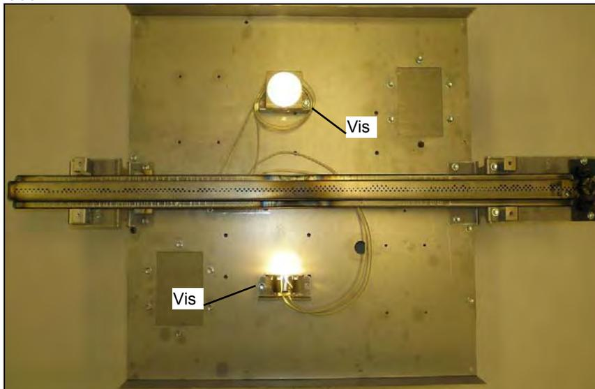
**ÉTAPE 3:** Positionnez les lampes dans la chambre de combustion. Fixez au foyer avec une vis aux endroits indiqués ci-dessus pour chaque appareil. Les lampes peuvent être pointées vers l'avant ou les côtés. Remplacez le tube du brûleur et le faux-plancher, ainsi que l'écran de veilleuse.
