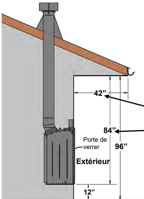
Un espace couvert (corniche) d'au moins la **1/2 de la distance entre la base du foyer et le plafond** (dessous de la toiture) est nécessaire.
