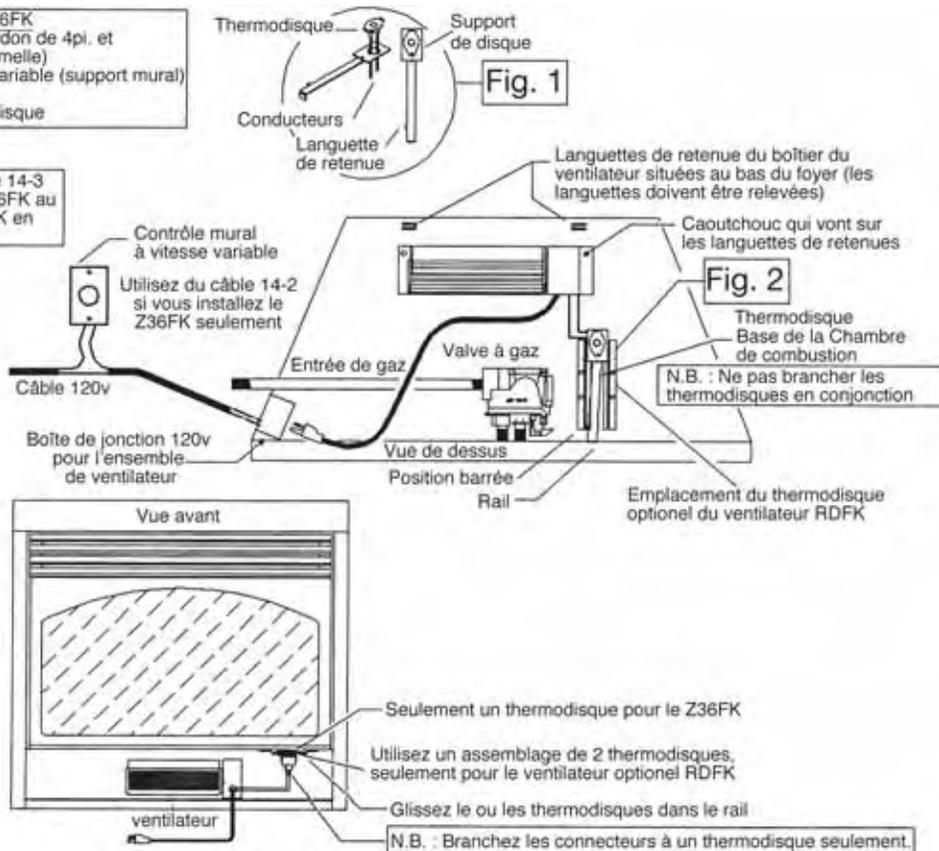
**ATTENTION : NE PAS BRANCHER LE VENTILATEUR 120 VOLTS AU SYSTÈME MILLIVOLT DE LA VALVE À GAZ**
