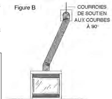
Pour les installations horizontales pour gaz propane il est recommandé qu'il y ait au moins 1pi de conduit vertical à partir du carneau du foyer avant le coude sur tout conduit horizontal de 1pi ou plus. Cela permet une combustion plus propre et réduit de beaucoup les dépôts de carbone et le besoin de nettoyer la vitre. (Ne s'applique pas aux modèles à carneau arrière.)
