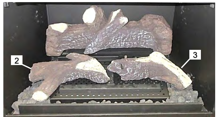
Ne placez pas les bûches 2 et 3 sur les ports du brûleur.
