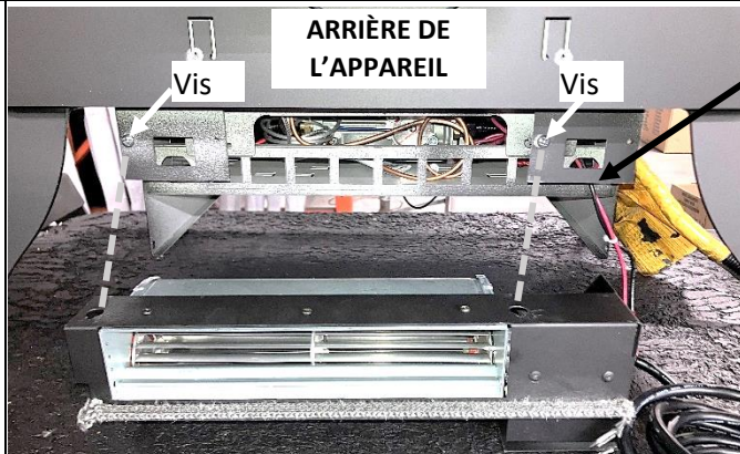
2. Passez les fils du ventilateur dans le trou, tel qu'illustré. Fixez le ventilateur sur les deux vis à l'arrière en utilisant les fentes en trou de serrure du boîtier du ventilateur.
