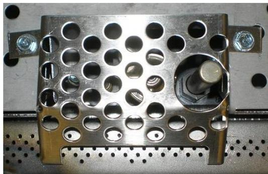
L'écran de la veilleuse doit être inspecté visuellement tous les mois pour déceler les signes de détérioration dus à l'exposition aux flammes. Remplacez si nécessaire.
