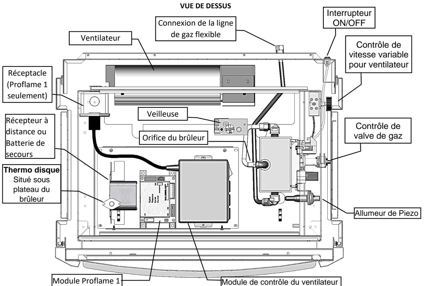
Le Proflame2 IFC (contrôle intégré de foyer) est un système qui permet la supervision de l'allumage automatique et de la flamme de veilleuse, pour commander les fonctions d'un foyer. Reportez-vous à la section Proflame 2 pour plus d'informations.
