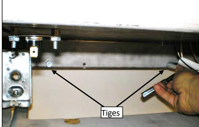
2. Enlevez les écrous des tiges en utilisant une clé ou une douille de 7/16".
