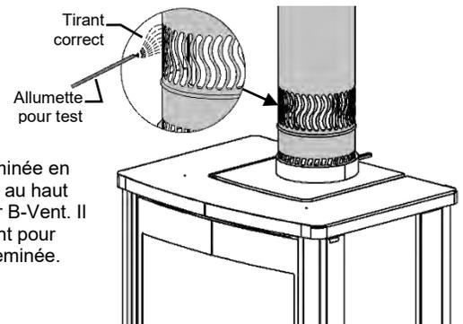
5. Vérifier le tirant de la cheminée en faisant le test de l'allumette au haut des fentes du convertisseur B-Vent. Il doit y avoir un tirant suffisant pour aspirer la fumée vers la cheminée.
