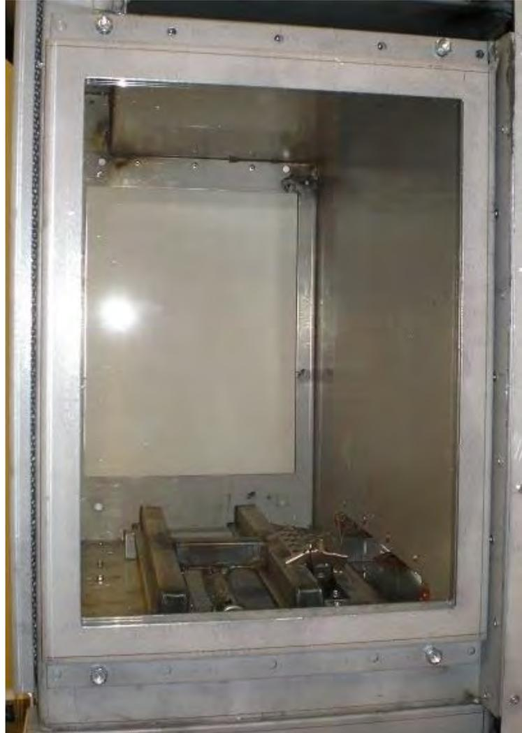
**N.B.** : Ne pas trop serrer les écrous, cela pourrait endommager la vitre ou le joint.
