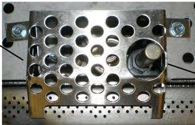
\*L'écran de veilleuse doit être inspecté visuellement une fois par mois pour voir s'il y a signe de détérioration due à l'exposition à la flamme. Remplacez si
