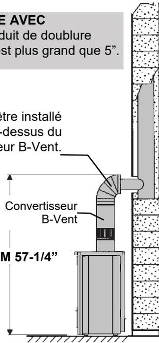
**CHEMINÉE B-VENT POUR COMBUSTIBLES LIQUIDES :** Conduit de doublure requis si le diamètre intérieur est plus grand que 6".
