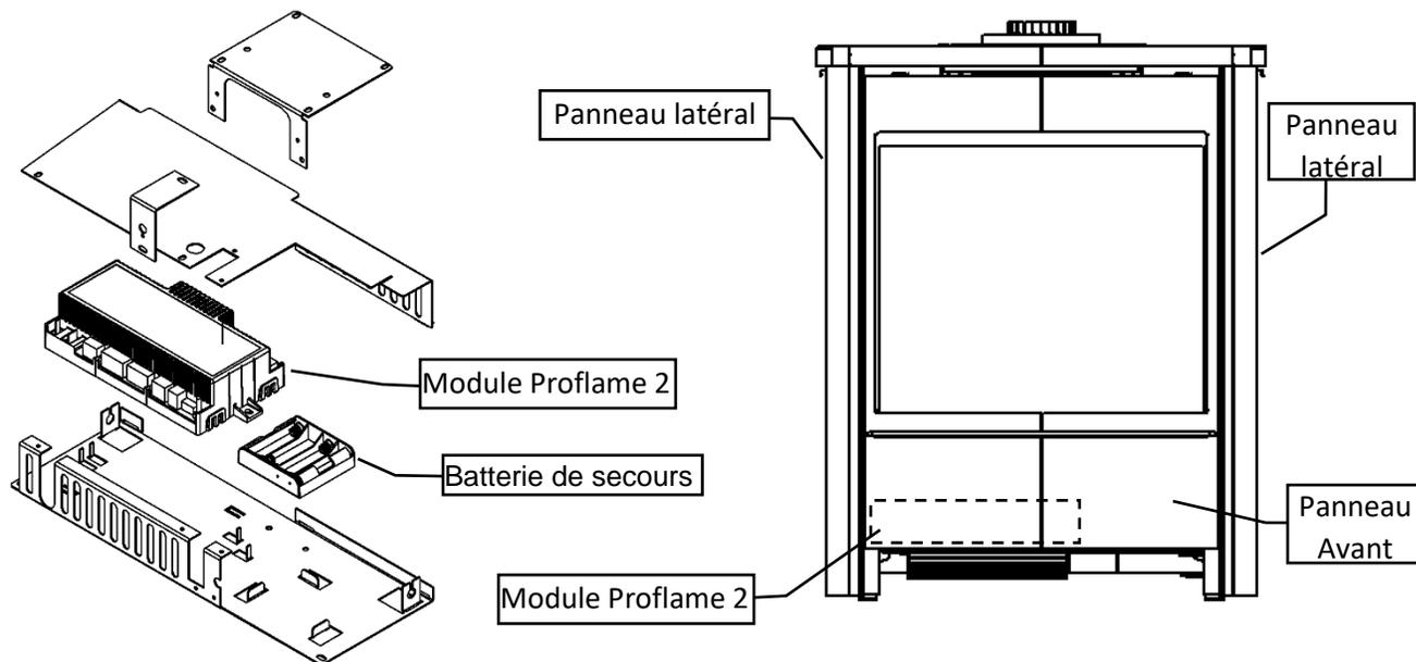
Le 51-UHS peut être inséré & retiré par le bas du foyer à travers l'ouverture du Panneau latéral gauche.
