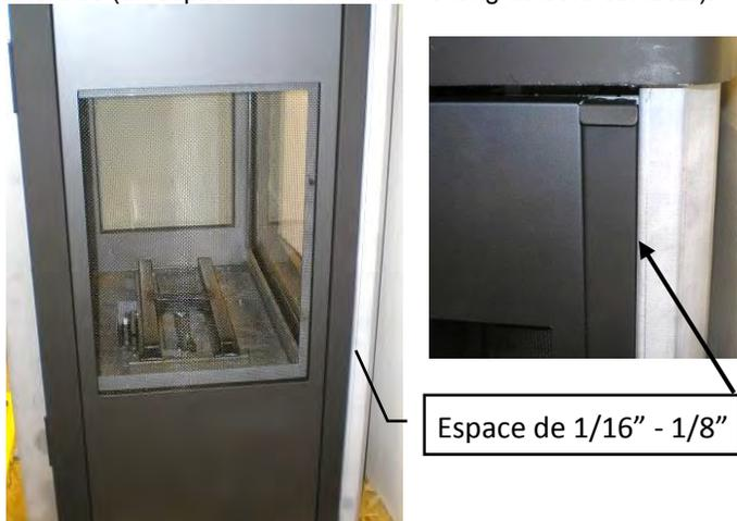
3. Déplacez les vis d'ajustement jusqu'à ce que le devant du panneau de porte latérale s'appuie sur l'appareil (tournevis cruciforme et clé 5/16" nécessaire).
