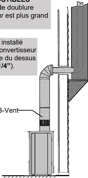
Un coude 90° peut être installé directement au-dessus du convertisseur B-Vent (La hauteur minimale du dessus du coude est de **57-1/4"**).
