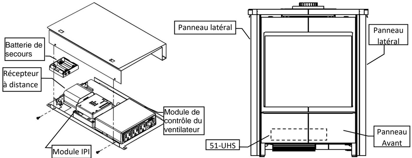
Le 51-UHS peut être inséré & retiré par le bas du foyer à travers l'ouverture du Panneau latéral.
