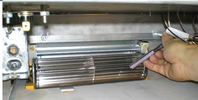
3. Fixez le ventilateur sur les tiges. Remplacez et serrez les écrous.
