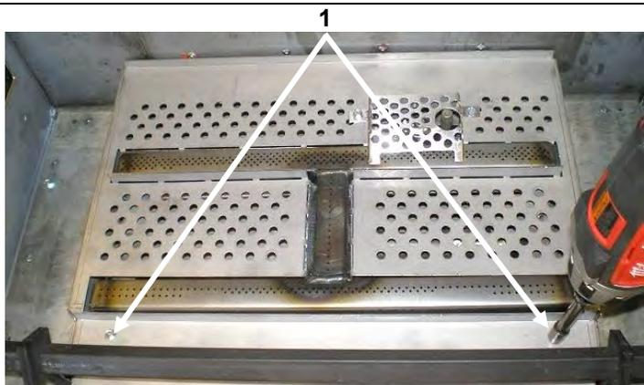
1. Enlevez les [2] vis DT qui sont derrière la grille et soulevez le faux plancher pour le sortir de la chambre de combustion.
