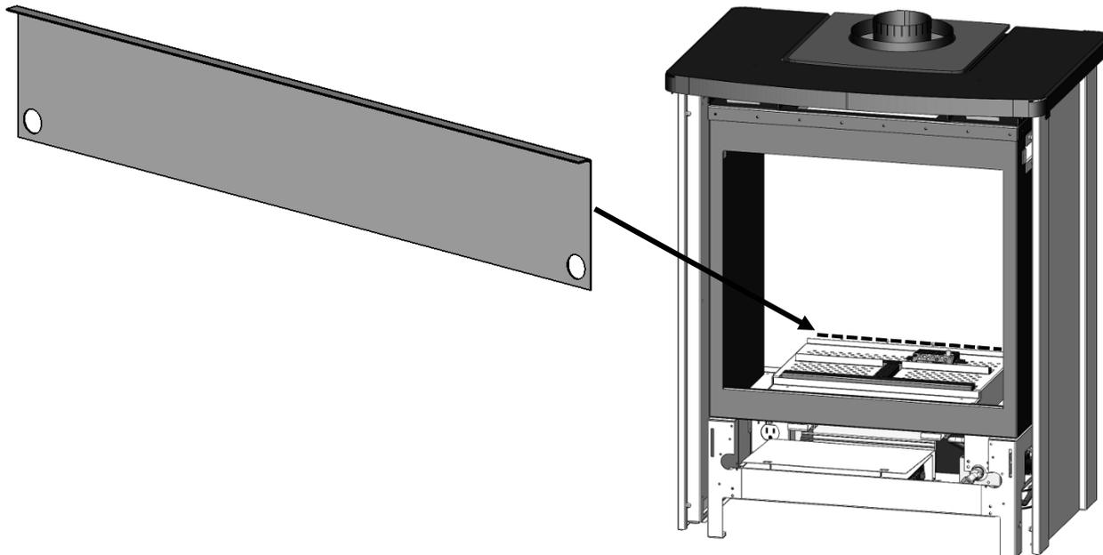
Pour utiliser le restricteur d'air, il suffit d'insérer derrière le faux-plancher, comme illustré.
