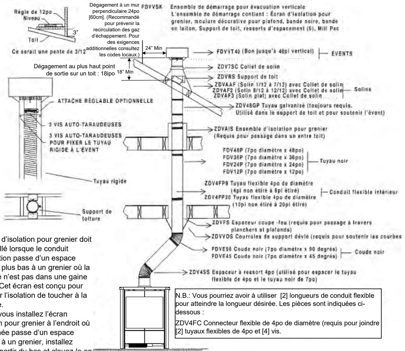
Un écran d'isolation pour grenier doit être installé lorsque le conduit d'évacuation passe d'un espace habitable plus bas à un grenier où la cheminée n'est pas dans une gaine isolante. Cet écran est conçu pour empêcher l'isolation de toucher à la cheminée.
