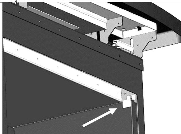
Les doublures latérales sont retenues par les crochets dans les coins supérieurs à l'avant de la chambre de combustion.
