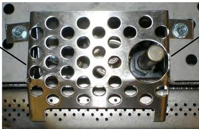
\*L'écran de veilleuse doit être inspecté visuellement une fois par mois pour voir s'il y a signe de détérioration due à l'exposition à la flamme. Remplacez si nécessaire.
