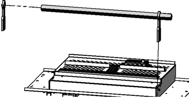
Étape 2 : Insérez les chenets dans les fentes du faux plancher.
