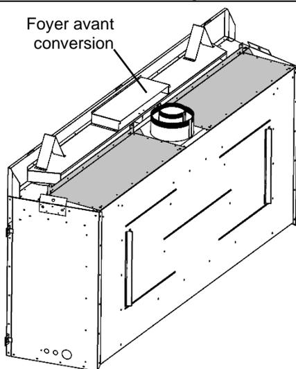
**ÉTAPE 1:** Retirez [Qté 2] plaques d'aération extérieures et [Qté 2] plaques d'aération intérieures.
