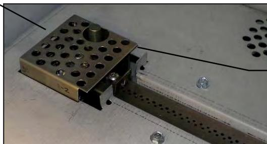
\*L'écran de veilleuse doit être inspecté visuellement une fois par mois pour voir s'il y a signe de détérioration due à l'exposition à la flamme. Remplacez si nécessaire.
