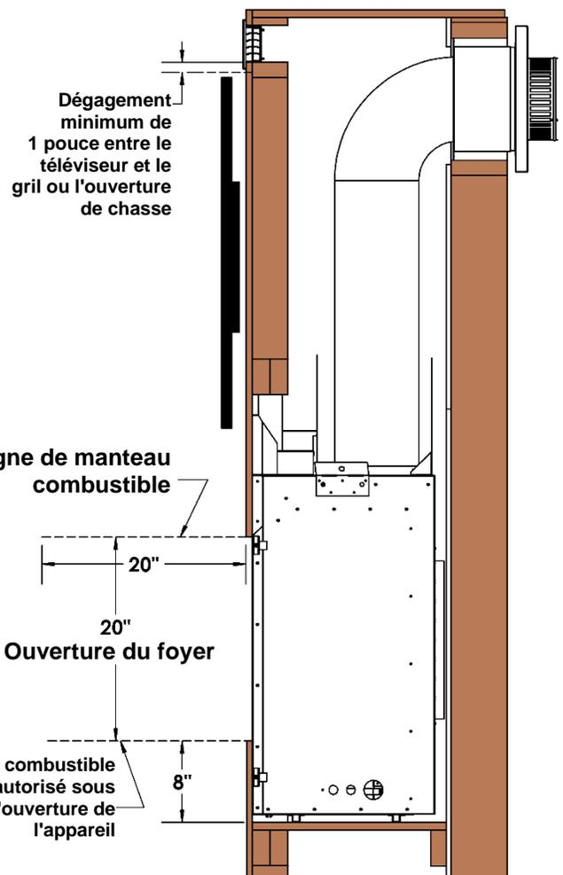
**⚠ N.B. :** Si vous utilisez de l'isolation dans une enchâssure ventilée (i.e. pour un mur extérieur), un panneau mural/gypse est nécessaire pour retenir l'isolant. L'enchâssure ventilée doit être propre et sans débris (i.e. isolant, pièces de bois, etc.).
