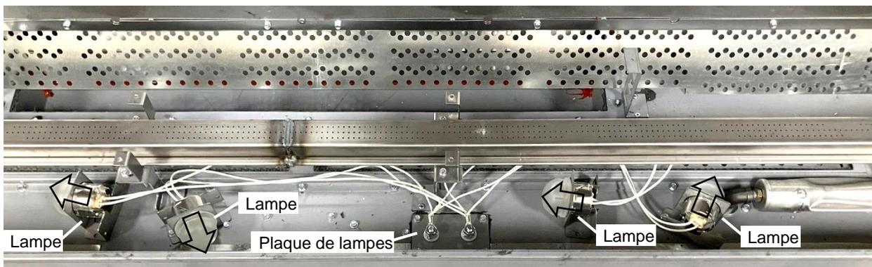
**ÉTAPE 5 :** Connectez les fils de l'interrupteur entre le fil de la lampe et le transformateur (voir schéma). Connectez le fil de lampe restant au transformateur ULK64. Le transformateur ULK64 peut ensuite être branché et placé sur les languettes situées au bas du foyer (voir photo ci-dessous).
