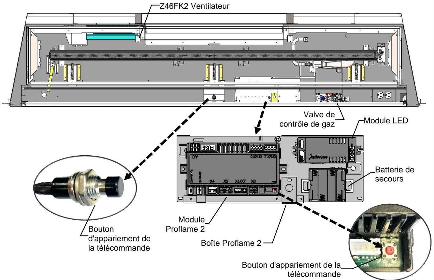
Le ventilateur doit être installé avant les matériaux de finition. Pour **enlever** le ventilateur pour réparation ou entretien, il faut d'abord enlever le plateau du brûleur et le travail doit être fait par cette ouverture. (Voir la section **Enlever le système de brûleur**).
