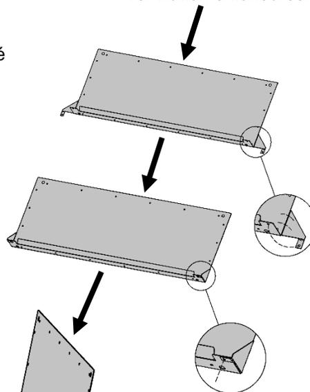
**ÉTAPE 4:** Installez les plaques de ventilation extérieures en position verticale.
