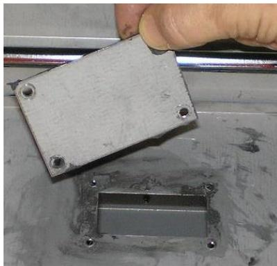
**ÉTAPE 3 :** Insérez les fils dans la gaine en passant par le trou de la chambre de combustion. Mettre du nouveau scellant Mill-Pac autour de l'ouverture et fixez la plaque à bornes avec des vis.
