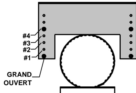
Pour ajuster le restricteur de carneau, il faut enlever les vis DT du haut de la chambre de combustion et placer le restricteur sur l'ouverture carneau, de façon à ce qu'il la bloque en partie. **Remplacez TOUTES les vis DT.**
