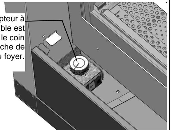
**N.B. : Ne laissez pas les câbles ou fils électriques entrer en contact avec la chambre de combustion ou le dessous du plateau du brûleur.**
