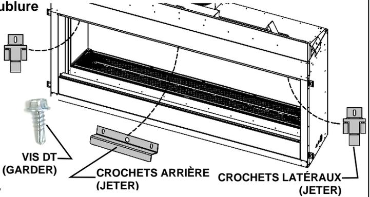
**ÉTAPE DEUX :** Retirez la barrière du plateau de média avec les 5 crochets de doublure inférieurs qui y sont attachés.
