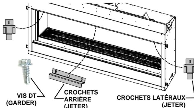
**ÉTAPE DEUX:** Retirez la barrière du plateau de média avec les 5 crochets de doublure inférieurs qui y sont attachés.
