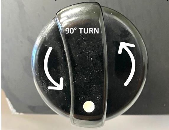
3. (a) Une fois que l'allumeur fait des étincelles, appuyez sur la poignée de la valve à gaz pour permettre l'arrivée de gaz. La flamme devrait s'allumer en 2 à 15 secondes. Si la flamme s'allume et reste allumée, passez à l'étape 4. Si la flamme ne s'allume pas, relâchez la poignée de la valve à gaz et le bouton de l'allumeur et allez à l'étape 3(b).
