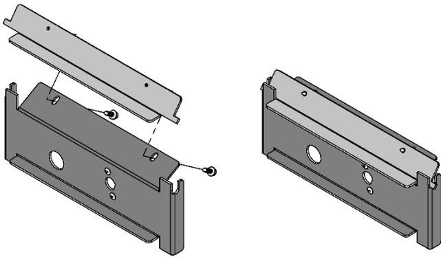
Le panneau de contrôle manuel de la valve doit être situé à 12" ou moins du support de l'orifice du brûleur.
