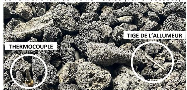
Vérifiez aussi que la tige de l'allumeur n'a pas été pliée et qu'elle ne touche pas le tube de laiton en dessous d'elle. Il devrait y avoir un espace d'environ 1/4" à 3/8" entre la tige de l'allumeur et le tube de laiton. S'il n'y a toujours pas d'étincelle, vérifiez que le filage est correctement branché à la tige de l'allumeur et qu'il n'y a pas de fissures ou de fil dénudé. Vous pouvez aussi changer la pile de l'allumeur si nécessaire.
