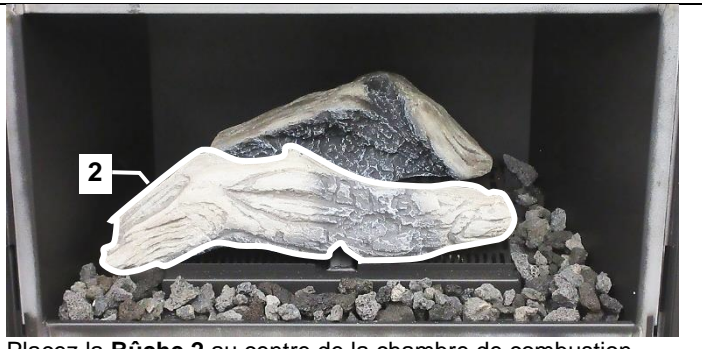
Placez la Bûche 2 au centre de la chambre de combustion directement au-dessus du brûleur. Placez la Roche volcanique sur les côtés et à l'avant du fond de la chambre de combustion.
