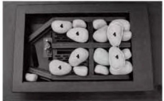
ÉTAPE 3 : Placez les roches #4 en position, tel que montré. Placez les deux roches qui sont entourées sur la photo, par-dessus la portion à port simple du tube transversal du brûleur.
