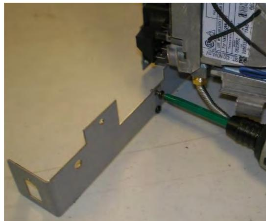
Fixez le support allongé de l'interrupteur en utilisant [2] vis combo #6, tel qu'illustré.
