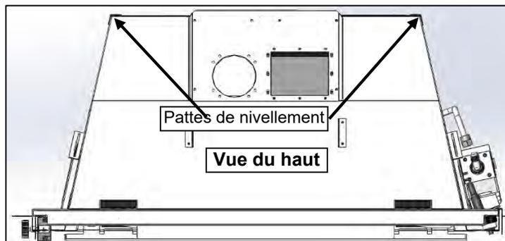
**IDV33 et IDV43** : Il y a deux pattes de nivellement à l'avant (pour les installations en retrait) et deux pattes de nivellement à l'arrière sur les côtés de l'appareil. Enlevez les vis pour ajuster la hauteur. Remplacez les vis.
