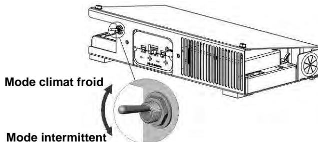
Cet appareil peut fonctionner avec la veilleuse continuellement allumée (mode climat froid) ou en mode intermittent. Dans la plus part des cas, le mode intermittent est préférable (il consomme moins de carburant). Toutefois, dans certaines situations il est préférable de placer l'appareil en mode climat froid. Les raisons les plus courantes de passer en mode climat froid sont :
