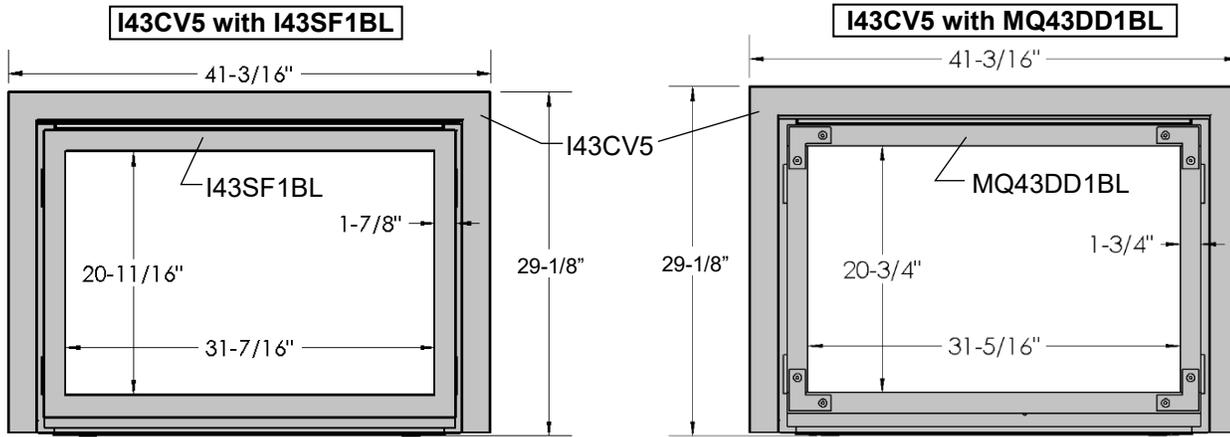
**I43CV5 dans une ouverture minimale (30-3/4" large, par 25-5/8" haut, par 14-3/4" profondeur - I43BT4230 ou I434432 requis)**
