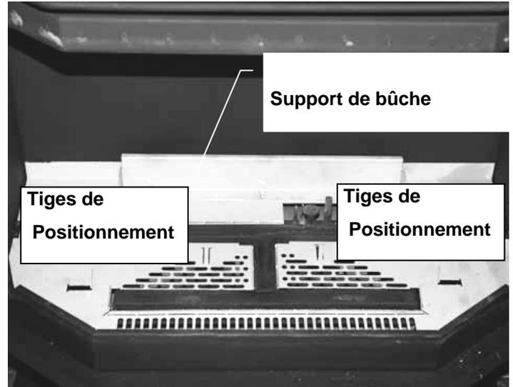
Cette illustration montre le support de bûche arrière et les 4 tiges de positionnement.
