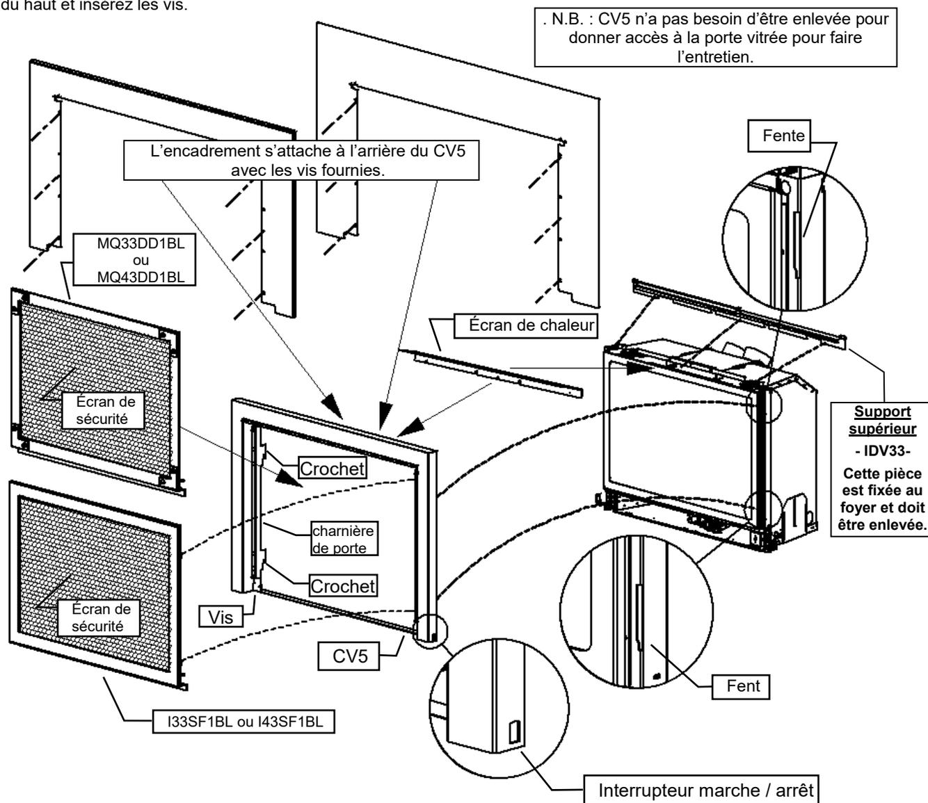
Écran de chaleur, il doit être installé après que le CV5 soit fixé au foyer.
