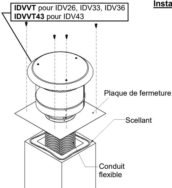
1. Avant d'attacher les conduits flexibles à l'évent, vous devez déterminer comment le capuchon sera fixé à la cheminée existante ou au tuyau de poêle à bois. La plaque de fermeture doit être coupée, encochée et formée pour bien s'adapter au dessus de la cheminée existante pour permettre un joint étanche.
