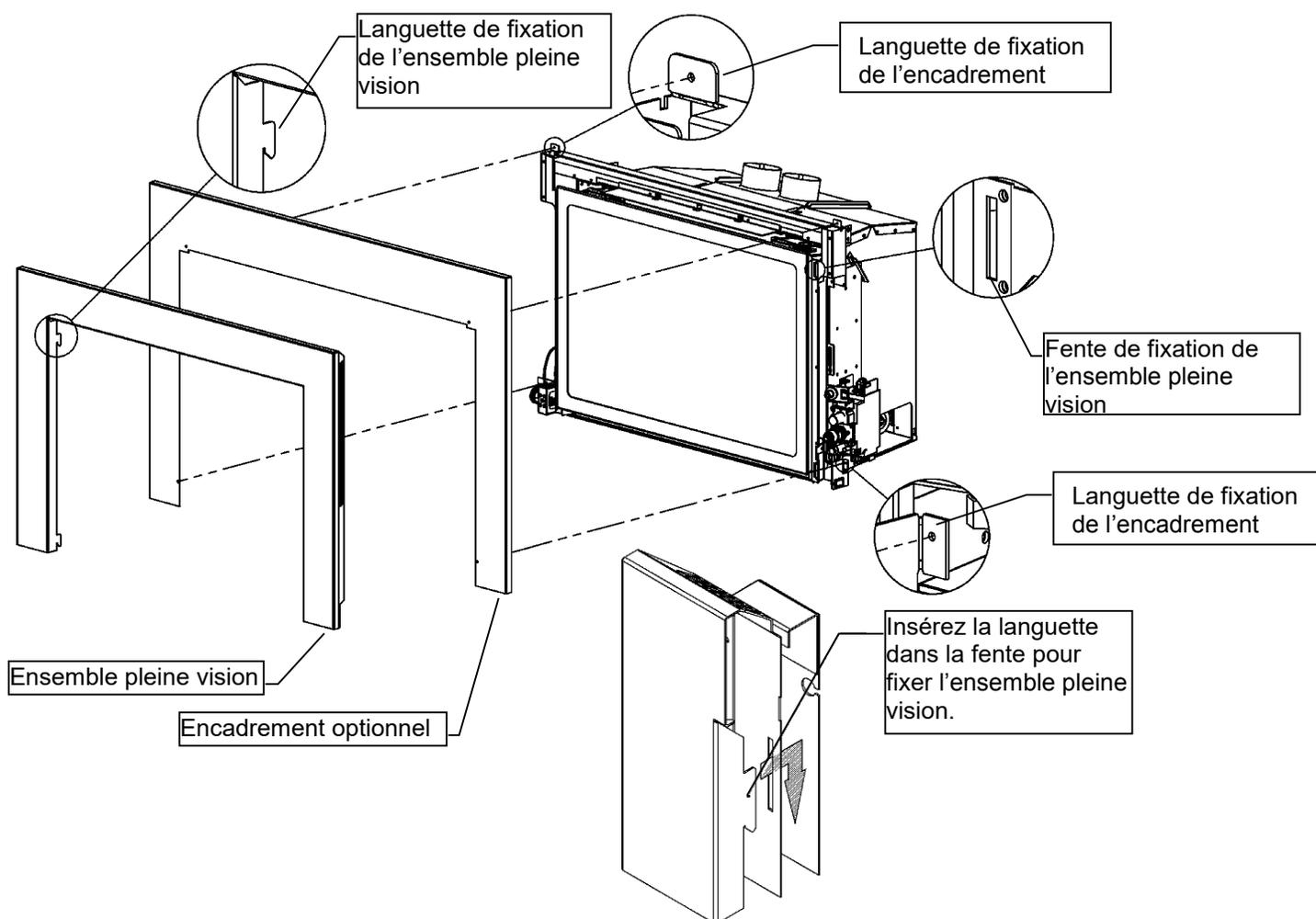
**N. B. : L'ensemble pleine vision doit être enlevé pour permettre l'accès à la porte vitrée, la valve, et pour faire le service de l'appareil.**
