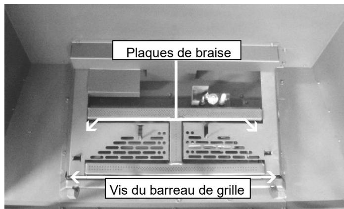
Enlevez les plaques de braise et le barreau de grille en enlevant les 2 vis à gauche et à droite du barreau.
