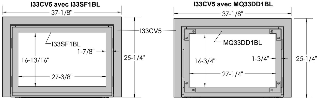
**I33CV5 dans une ouverture minimale (26-3/8" de large, par 21-3/8" de haut, par 14-3/8" de profondeur I33BT1 requis)**
