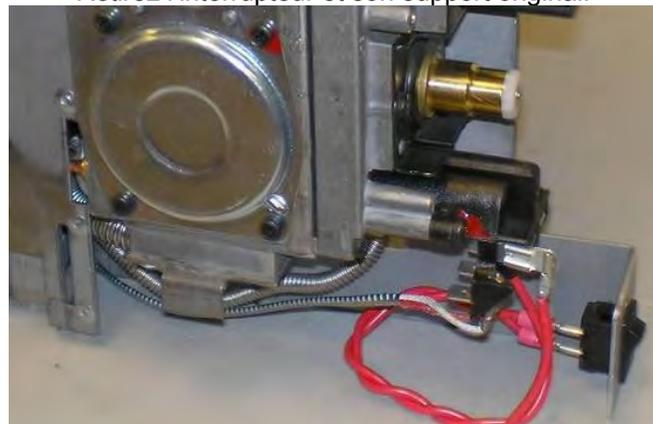
Fixez le support allongé de l'interrupteur en utilisant [2] vis combo #6, tel qu'illustré.
