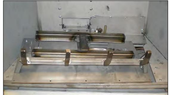
Pour réinstaller, les surfaces doivent être propres, et tout le vieux scellant enlevé. Scellez avec du scellant Millpac haute température et fixez avec les douze [12] vis.
