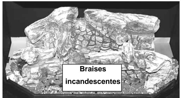
Un sac de morceaux de braise est fourni avec l'appareil. Il est très important que ces morceaux soient placés sur le devant du brûleur et le plateau, tel que montré sur cette photo. Étendez les morceaux de braise pour qu'il n'y ait qu'une couche d'épais. **N.B. :** Si vous ne suivez pas ces instructions correctement il pourrait y avoir des problèmes de suie.
