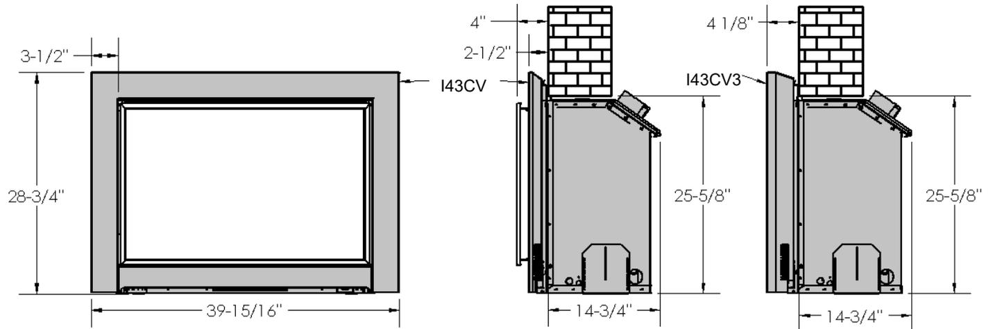
N.B.: I43CV et I43CV3 a un profil aminci. Voir les **Couverture des encadrements et ensembles pleine vision.**
