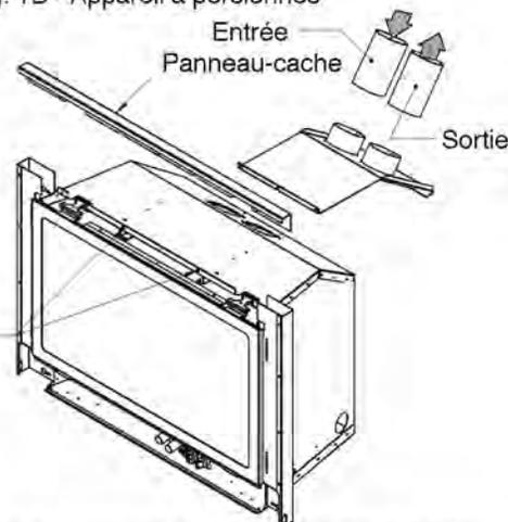
Fig.3 - Enlevez le panneau cache supérieur pour installer l'adaptateur
