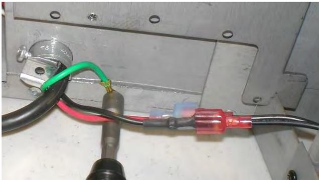
**N. B. :** Si le fil de mise à la terre est fixé à la plaque latérale des composantes, défaites-le et fixez-le au côté de l'appareil avec une vis DT.
