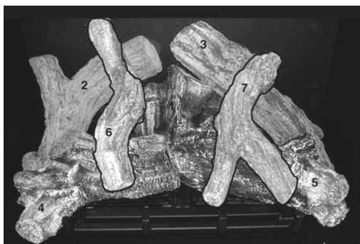
Localisez le trou sous la bûche #6 et placez-le sur la tige de la bûche #2. Localisez les 2 trous sous la bûche #7 et placez-les sur les tiges de la bûche #5.
