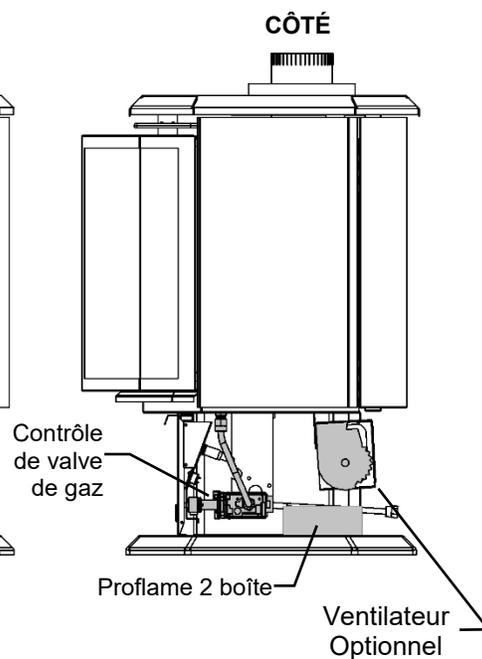
La boîte de Proflame 2 peut être insérée et enlevée par l'ouverture à l'arrière de la base de piédestal.
