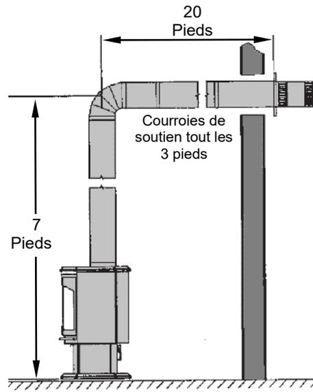
La longueur maximum d'un conduit d'évacuation comprenant un coude à 90 degrés est de 20pi avec 7pi vertical.
