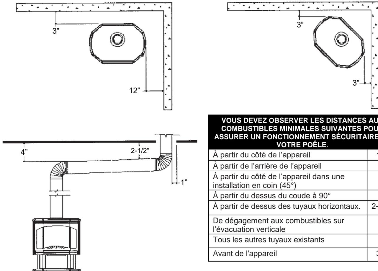
Cet appareil devrait être placé sur une surface solide et stable. L'appareil peut être installé directement sur du tapis, de la tuile ou autre matériaux combustibles sans qu'aucune protection de plancher additionnelle soit nécessaire.
