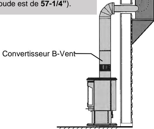
Un coude 90° peut être installé directement au-dessus du convertisseur B-Vent (La hauteur minimale du dessus du coude est de 57-1/4").
