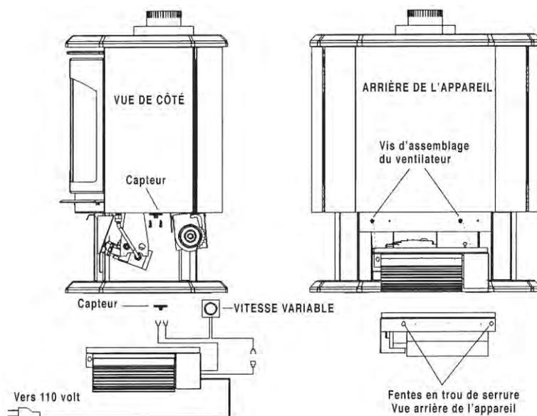
1. Ouvrez la porte d'accès avant à l'endroit où l'allumeur piézoélectrique est situé. Enlevez les deux vis qui maintiennent le panneau de contrôle en place, tirez le panneau de contrôle vers vous et installez le contrôle à vitesse variable dans le trou du côté opposé de l'allumeur piézoélectrique.
