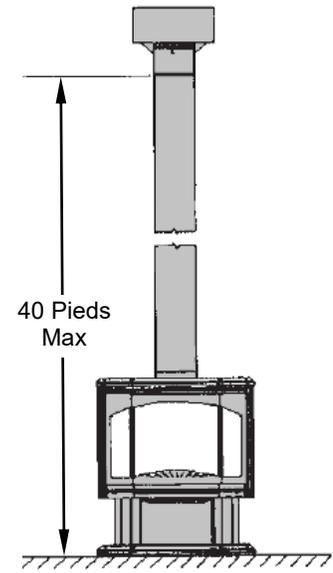
La longueur maximale de conduit vertical est de 40pi
