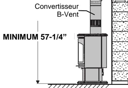
**CHEMINÉE B-VENT POUR COMBUSTIBLES LIQUIDES :** Conduit de doublure requis si le diamètre intérieur est plus grand que 6".
