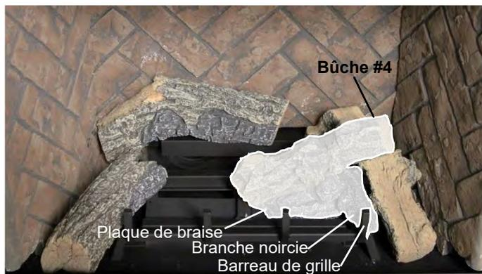
**Étape 4 :** Placez la partie aplatie de la **bûche #4** sur la plaque de braise, en s'assurant qu'elle soit complètement scellée. La branche noircie de la bûche #4 doit être contre le barreau de grille.
