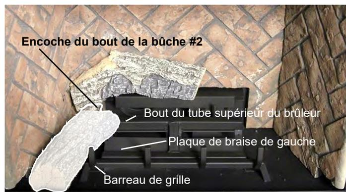
**Étape 2 :** Placez l'encoche de la **bûche #2** sur la plaque de braise de gauche et contre le bout du tube supérieur du brûleur. Ensuite déposez la partie aplatie de la bûche #2 sur le plancher de la chambre de combustion et contre le barreau de grille de gauche.
