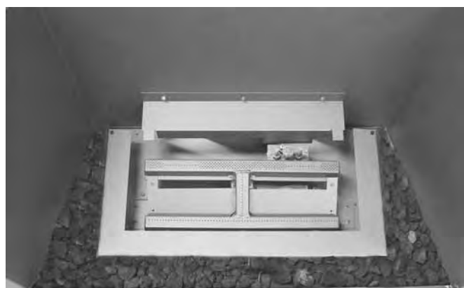
Étape 4 : replissez la plateforme pour roche avec les pierres de lave. Saupoudrez la vermiculite sur les pierres. Ne pas placer de pierres ou de vermiculite sur le tube du brûleur.
