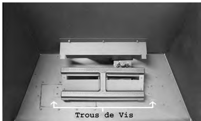
Étape 2 : replacez/réinstallez les 2 vis du barreau de grille.
