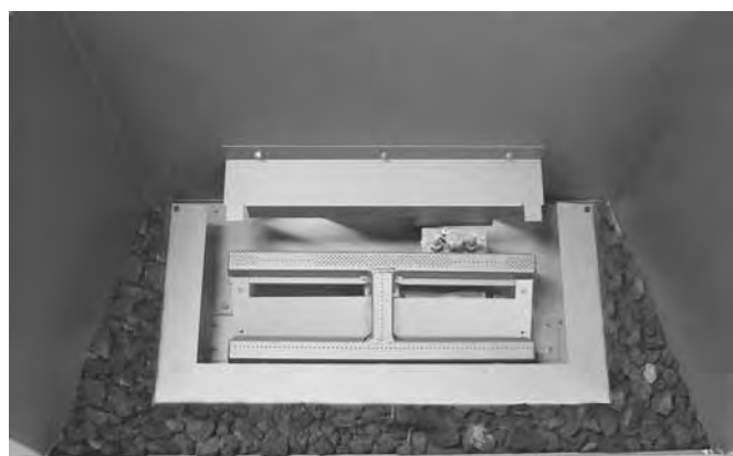
Étape 4 : replissez la plateforme pour roche avec les pierres de lave. Saupoudrez la vermiculite sur les pierres. Ne pas placer de pierres ou de vermiculite sur le tube du brûleur.
