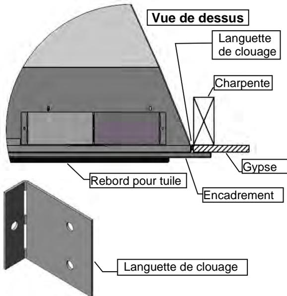
**Charpente à égalité avec la façade du foyer -** Le foyer doit être recouvert de matériaux non combustibles (ex. : panneau de ciment). **N.B. : 1/2" DOIT ÊTRE AJOUTÉ À LA PROFONDEUR DE CHARPENTE DE L'APPAREIL. UTILISEZ CETTE MÉTHODE POUR LES ENCADREMENTS ZCVRB3622.**
