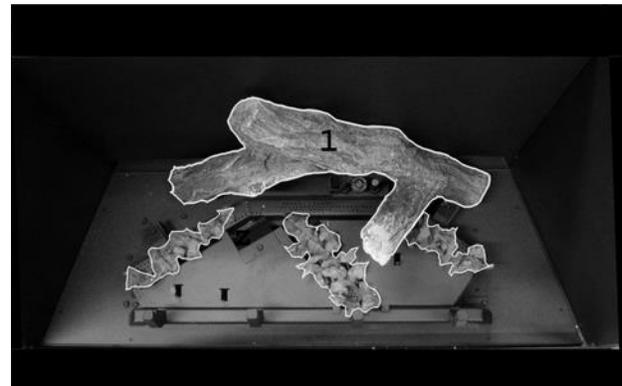
**Étape 1 :** Placez les deux morceaux de la bûche #1 sur le plateau du brûleur arrière en la glissant vers la gauche jusqu'au support du brûleur de droite.
