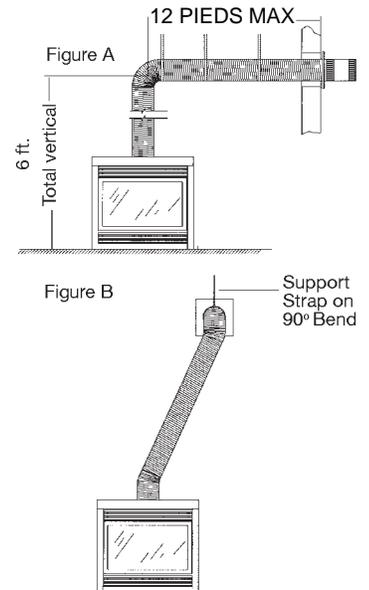
**Important :** La distance minimale entre le tuyau d'évacuation et les matières combustibles est de 1po (2.5cm)
