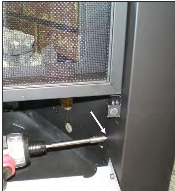
Étape 4: Ouvrez le panneau inférieur et installez les vis au travers de l'encadrement. Relevez le panneau inférieur et remplacez ses vis.
