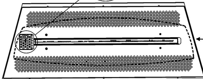
**Disposition de la braise de verre du ZCVRB3622 & MQRB4236:** Laissez 3-4 rangés de perforations libres à l'avant et à l'arrière du faux-plancher. Recouvrir toutes les perforations de l'arrière peut causer un retour de flamme.
