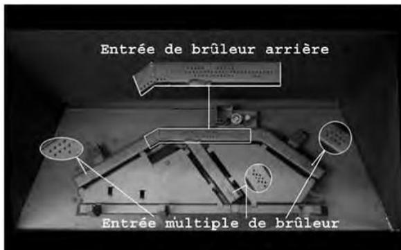
Placez la laine de roche sur le brûleur, tel qu'indiqué dans l'étape 1. Assurez-vous de ne pas obstruer les ouvertures des entrées multiples de brûleur. Pour GPL seulement, les entrées multiples peuvent être complètement couvertes. **Ne pas couvrir l'entrée de brûleur arrière avec la laine de roche.**
