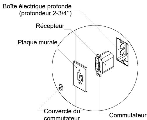
N.B. : Le récepteur peut aussi être placé à l'extérieur de l'appareil à une distance maximale de 6 pi. Il doit être installé dans une boîte électrique profonde (2-3/4" de profondeur) certifiée. Pour cette configuration un câble électrique rallonge (no 1001-P904SI) est nécessaire.
