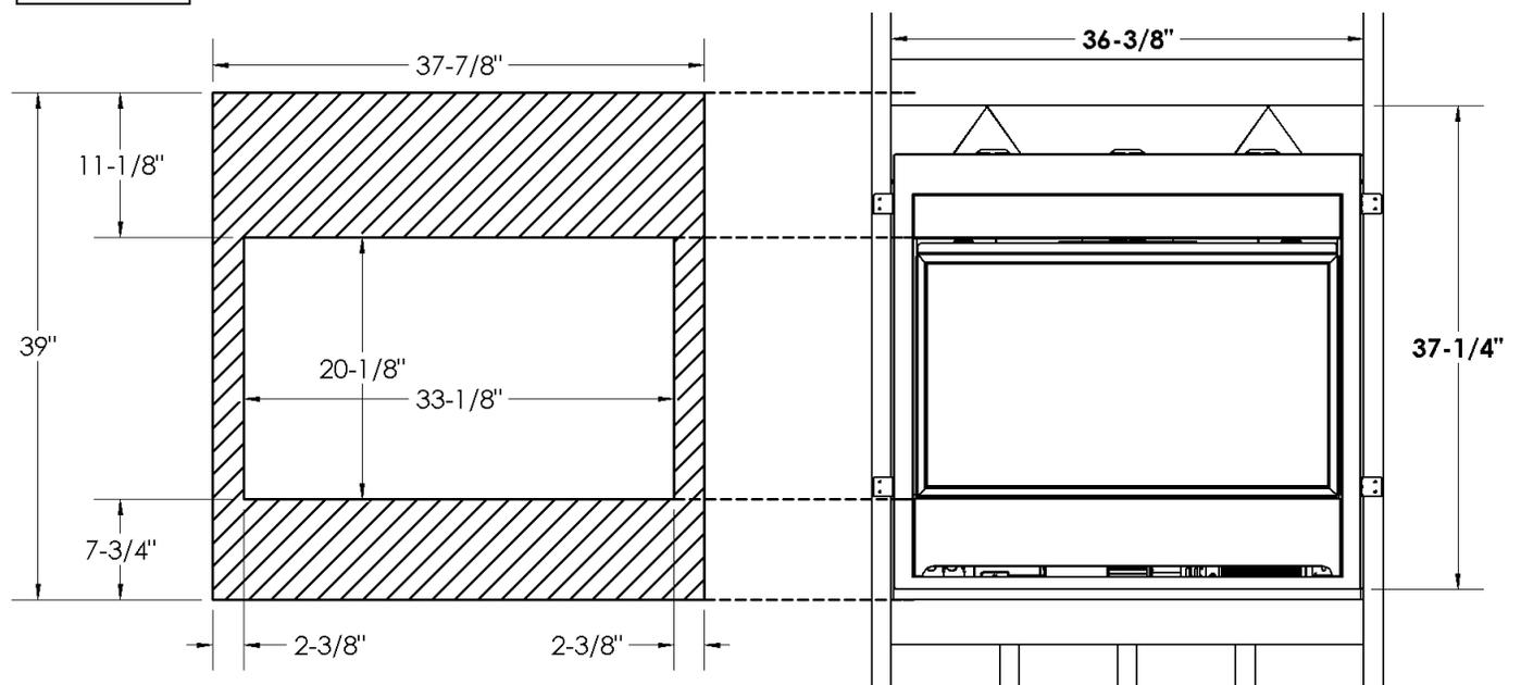
Avant d'installer quelque type de manteau que ce soit, il est important de déterminer si ses matériaux sont combustibles ou non. Il y a 2 types de manteaux à considérer : combustible et non combustible.
