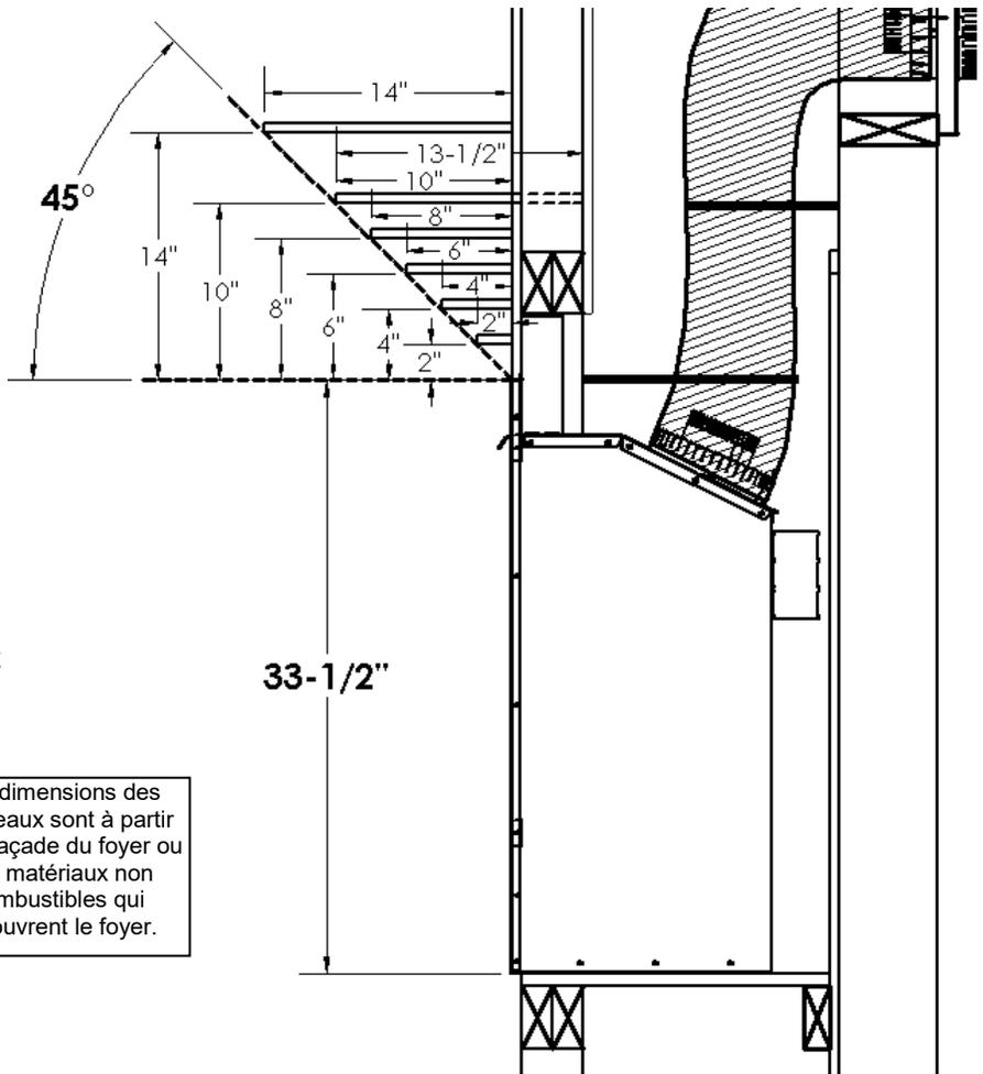
Les dimensions des manteaux sont à partir de la façade du foyer ou des matériaux non combustibles qui recouvrent le foyer.
