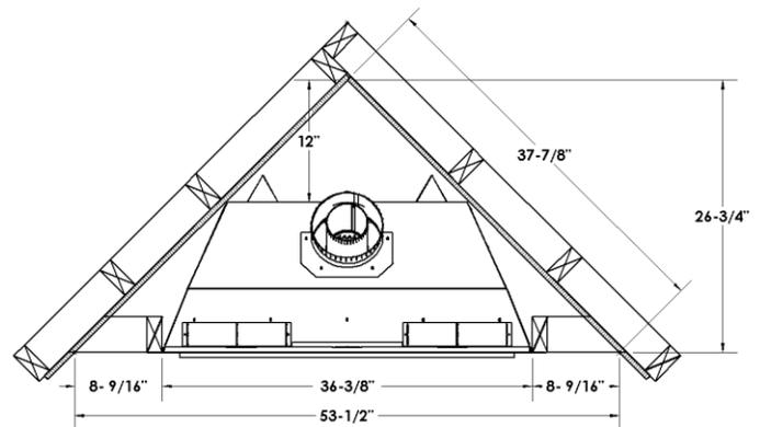
Charpente de l'évacuation horizontale (Voir la section **Évacuation à travers un mur**)
