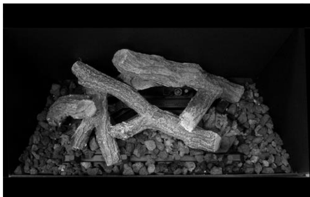
Étape 5 : Remplissez le reste du plateau du brûleur et de la plaque de braise avec la roche de lave et la vermiculite. Ne pas placer de roche ni de vermiculite sur aucune entrée du brûleur.
