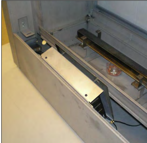
Le 51-UHS peut être inséré & retiré par le bas du foyer à travers l'ouverture du panneau d'accès (Enlevez la porte vitrée en premier).
