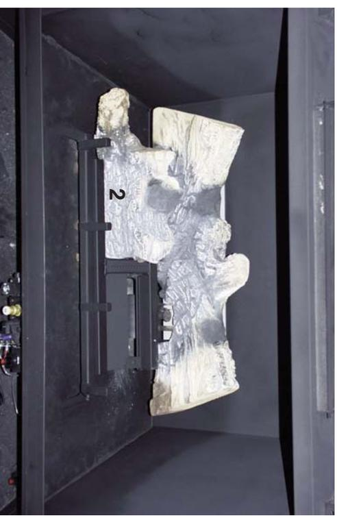
**Étape (2)** Localisez la surface plate sur la Bûche(2) et placez-la directement sur le plateau gauche des braises, poussez la bûche entièrement vers la droite jusqu'à ce qu'elle touche le tube transversal.
