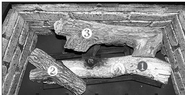
**ÉTAPE 4:** (Notez le trou sur la bûche 4, la base du noeud principale et la zone plate près de l'arrière de la bûche) Soulevez la bûche 3 approx. 2 pouces et placez la bûche 4 sous le noeud sur le dessus de la bûche 3. Placez le trou de la bûche 4 sur le lobe de la bûche 1, déposez la bûche 3 en place tel que montré. Placez la zone plate de la bûche 4 sur le support du brûleur arrière gauche et poussez vers l'arrière contre l'attache.
